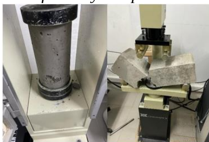
Figura 19. Ensayos de probetas a flexión y compresión
