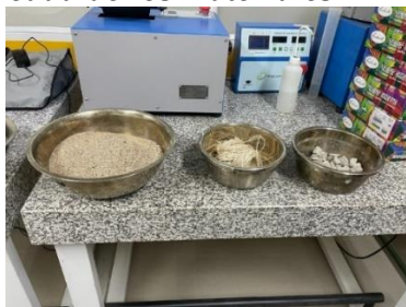
Figura 8. Condiciones de humedad de los materiales
