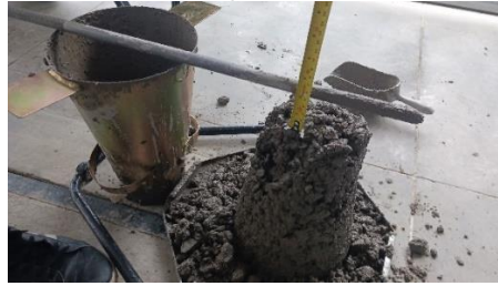
Figura 10. Concreto convencional en ensayo de asentamiento
