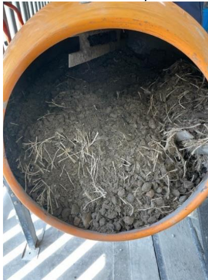
Figura 15. Mezcla del concreto con adición de tereftalato de polietileno y furcraea andina
