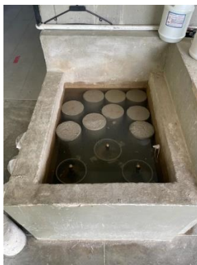
Figura 18. Tiempo de curado de cilindros de concreto con adición de tereftalato de polietileno y furcraea andina
