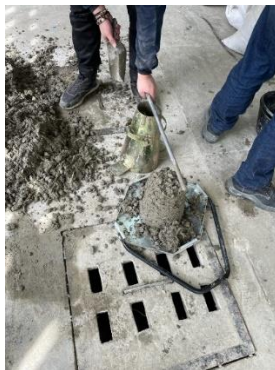
Figura 16. Concreto con adición de tereftalato de polietileno y furcraea andina en ensayo de asentamiento
