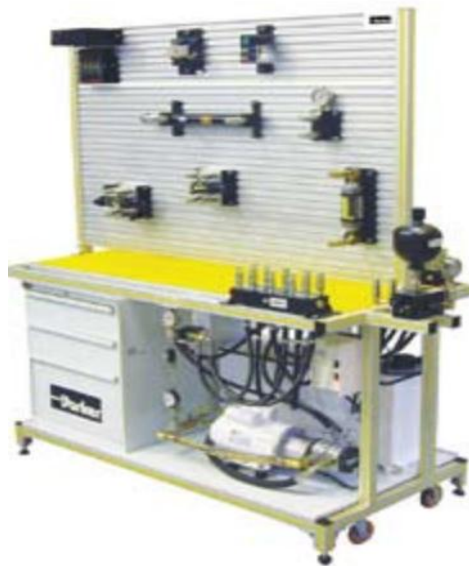
Imagen 2. Banco de entrenamiento hidráulico. [3]
