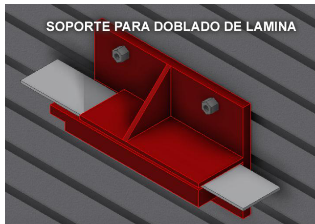
Imagen 8. Soporte de sujeción al tablero para doblado de láminas metálicas.
