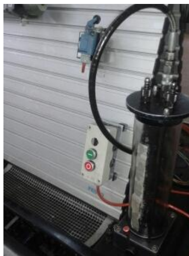
Imagen 7. Acumulador de presión.
