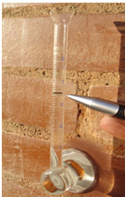
Ilustración 12. Ensayo in-situ de absorción con pipeta de Karsten.
