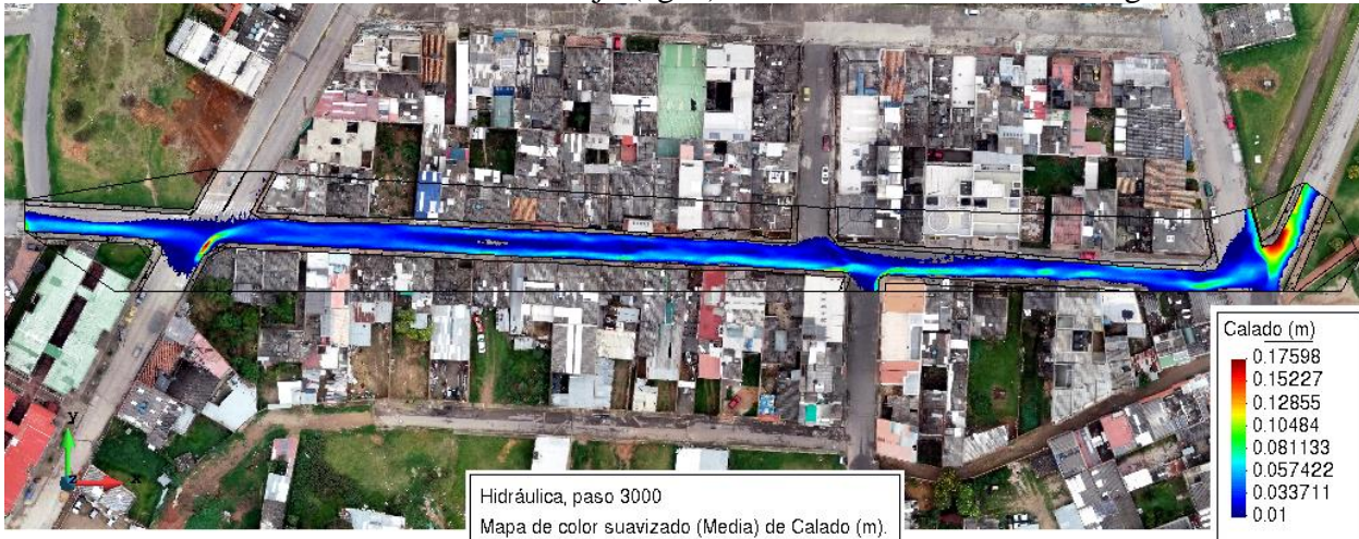
Ilustración 40. Resultado del calado de flujo (agua) en la modelación en 3000 segundos.
