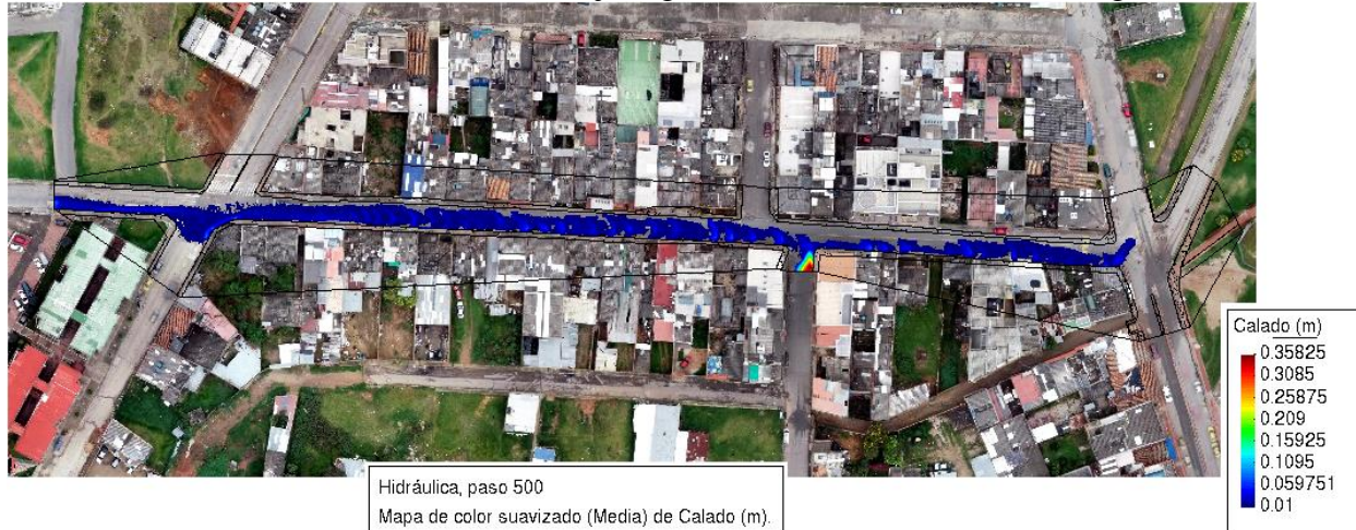
Ilustración 37. Resultado del calado de flujo (agua) en la modelación en 500 segundos.
