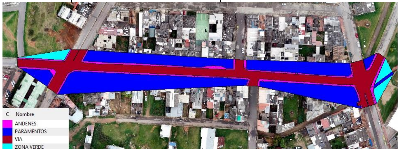
Ilustración 25. Superficies incluidas en el modelo IBER para ambos escenarios de simulación.
