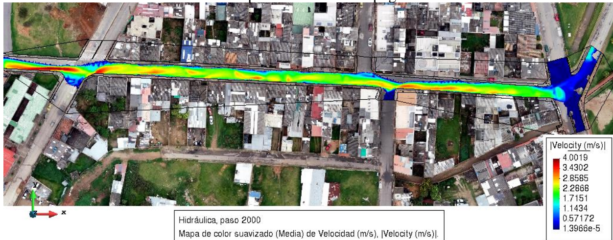
Ilustración 50. Resultado en velocidad para escenario de topografía tradicional.
