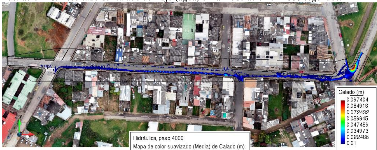
Ilustración 48. Resultado del calado de flujo (agua) en la modelación en 4000 segundos.
