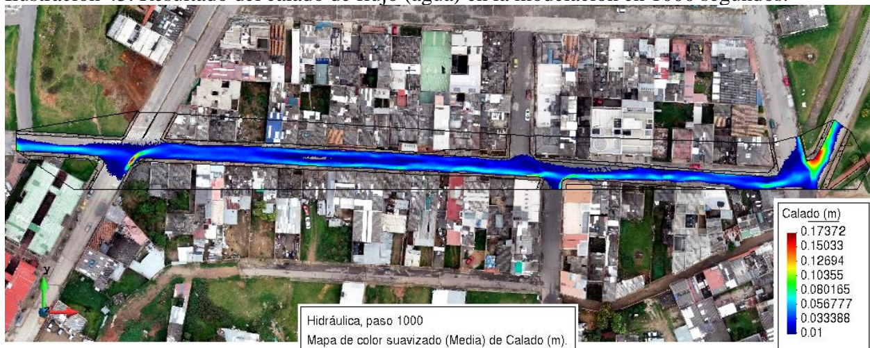
Ilustración 45. Resultado del calado de flujo (agua) en la modelación en 1000 segundos.
