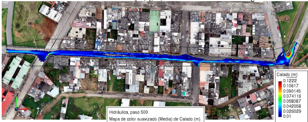
Ilustración 44. Resultado del calado de flujo (agua) en la modelación en 500 segundos.
