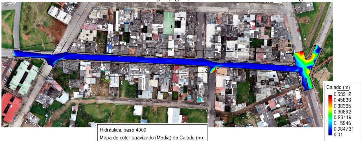
Ilustración 41. Resultado del calado de flujo (agua) en la modelación en 4000 segundos.
