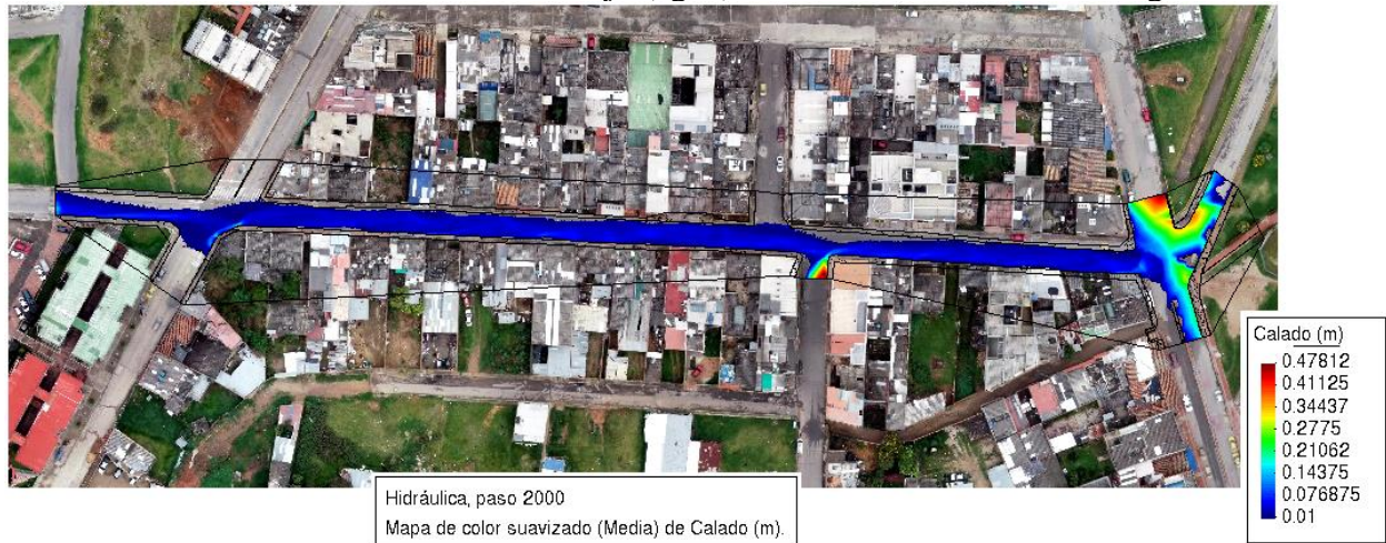
Ilustración 39. Resultado del calado de flujo (agua) en la modelación en 2000 segundos.
