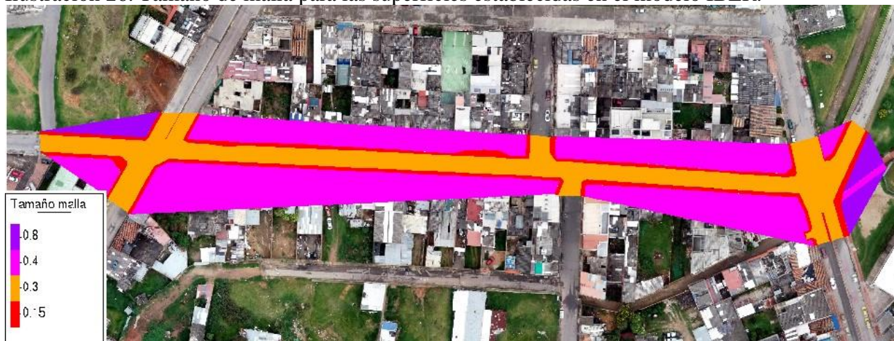
Ilustración 26. Tamaño de malla para las superficies establecidas en el modelo IBER.
