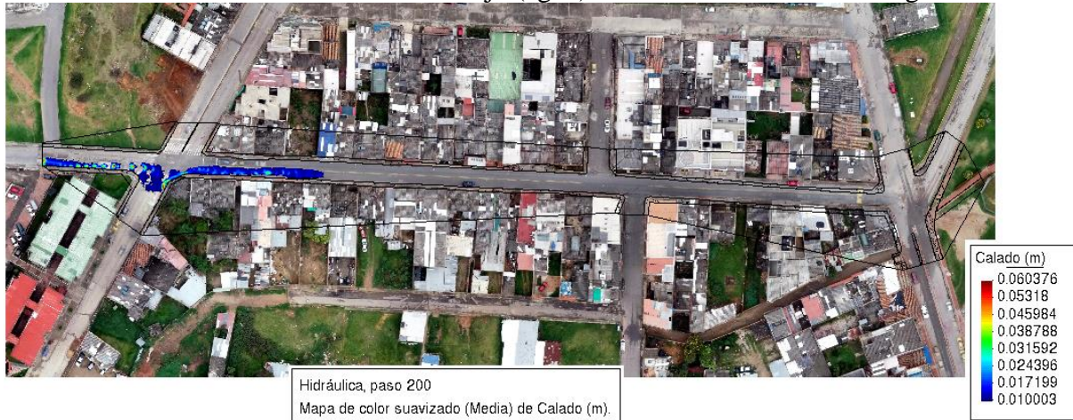
Ilustración 36. Resultado del calado de flujo (agua) en la modelación en 200 segundos.
