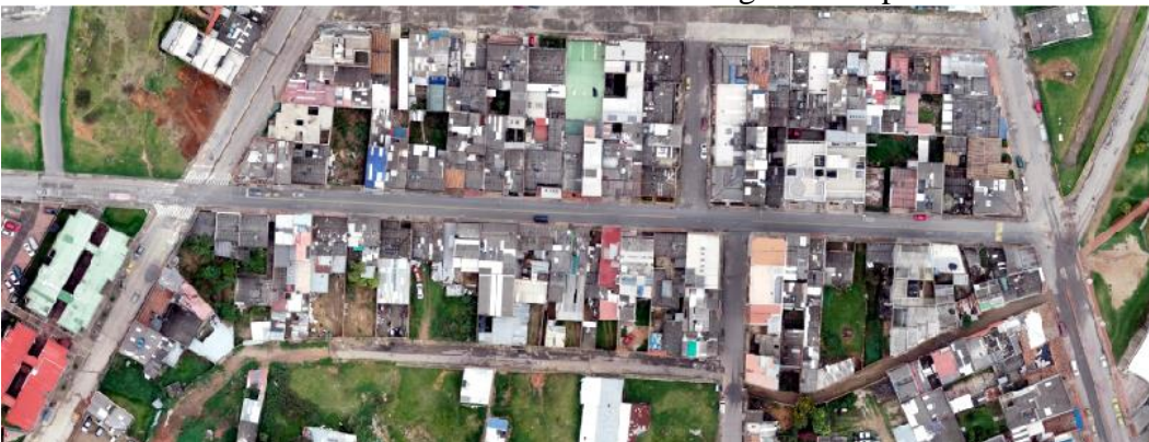
Ilustración 11. Ortofoto obtenido con fotogrametría por dron.
