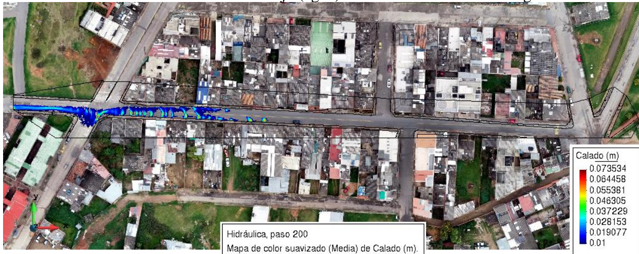
Ilustración 43. Resultado del calado de flujo (agua) en la modelación en 200 segundos.
