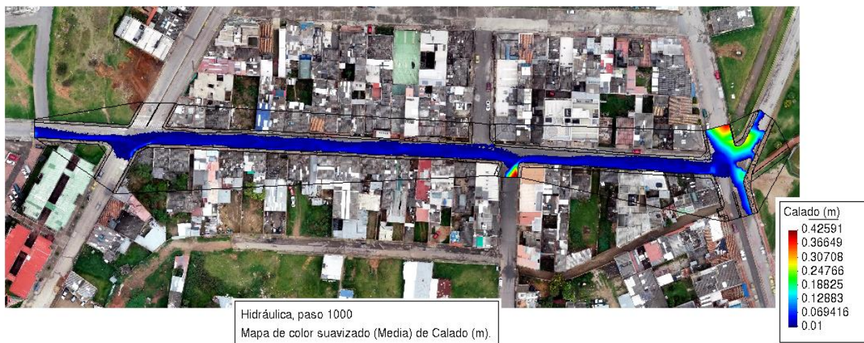
Ilustración 38. Resultado del calado de flujo (agua) en la modelación en 1000 segundos.
