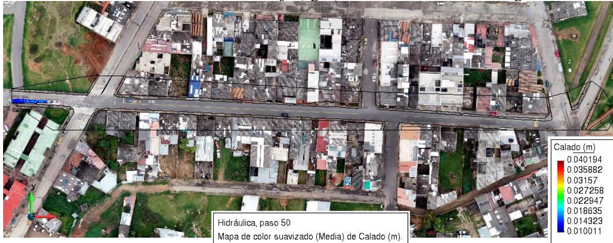
Ilustración 42. Resultado del calado de flujo (agua) en la modelación en 50 segundos.
