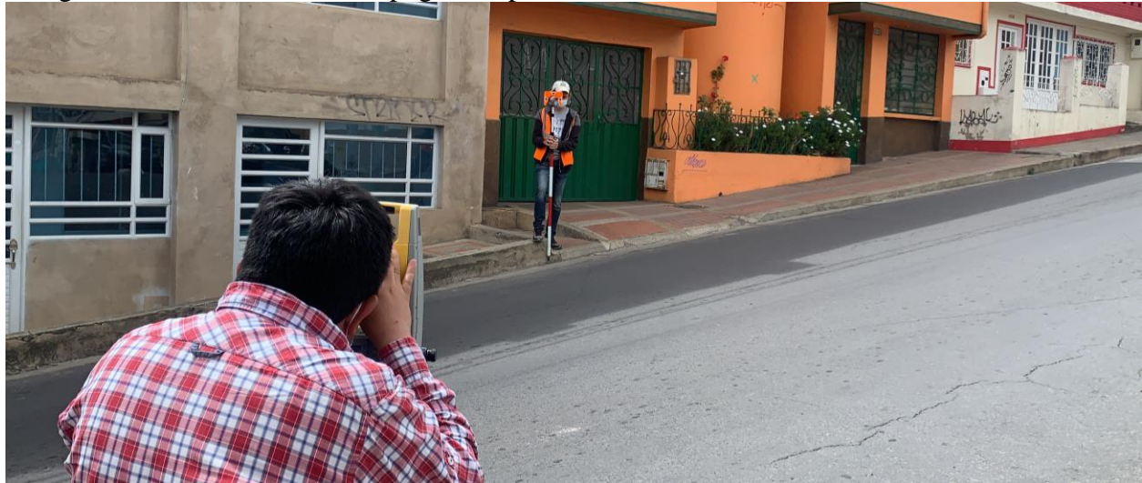
Fotografía # 2. Levantamiento topográfico por medio de estación total de la zona de estudio.
