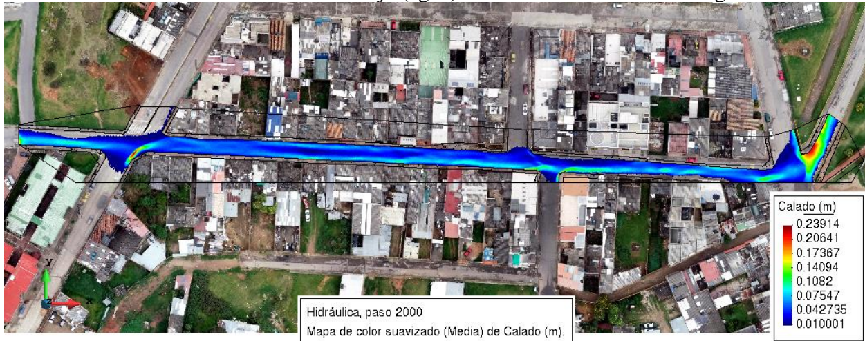
Ilustración 46. Resultado del calado de flujo (agua) en la modelación en 2000 segundos.
