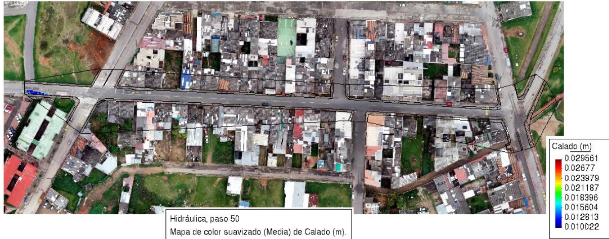
Ilustración 35. Resultado del calado de flujo (agua) en la modelación en 50 segundos.
