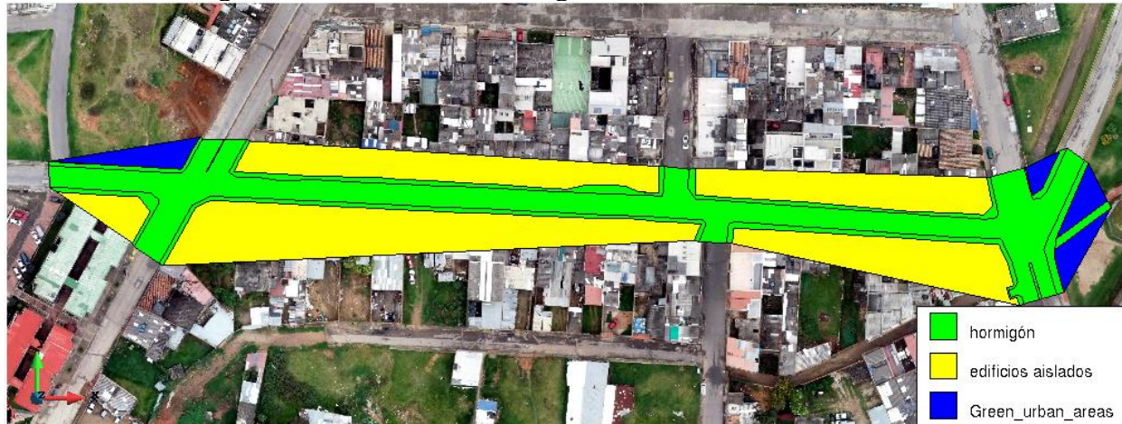
Ilustración 16. Asignación de coeficientes de rugosidad en IBER.
