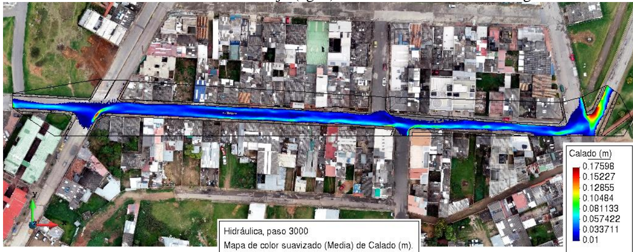
Ilustración 47. Resultado del calado de flujo (agua) en la modelación en 3000 segundos.
