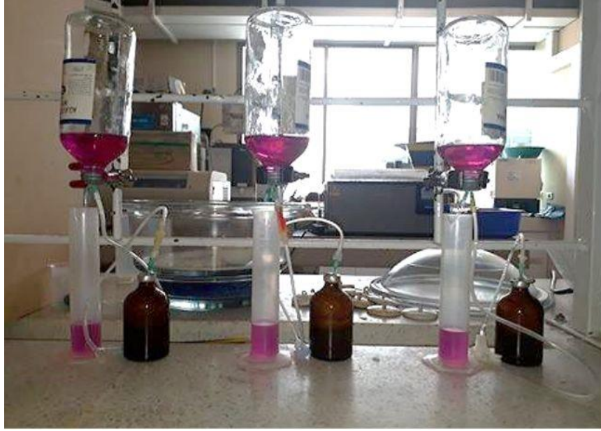
Figura 4. Montaje para la medición del biogás generado.
