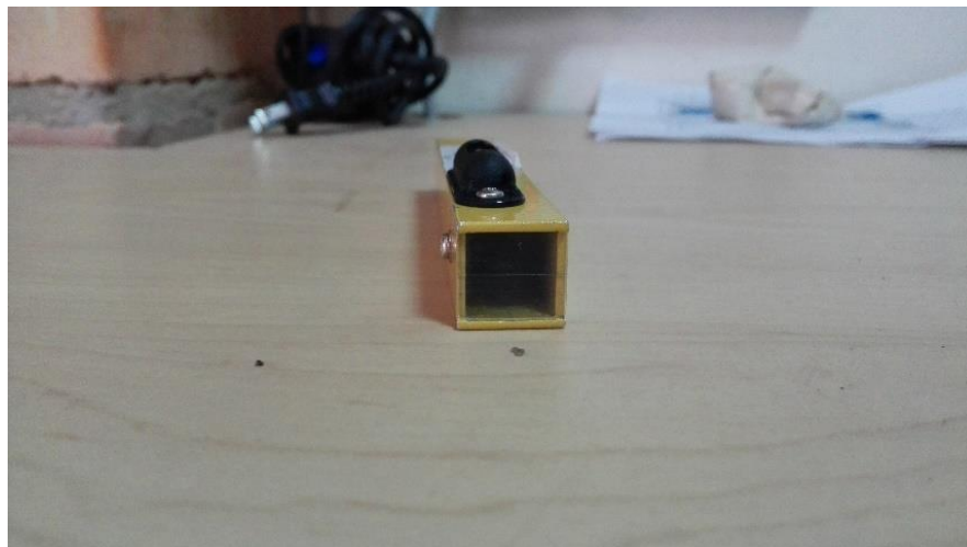
FOTOGRAFÍA 15. VISTA FRONTAL NIVEL LOCKE.
