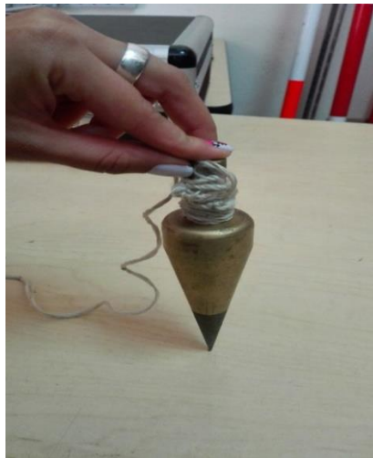
FOTOGRAFÍA 7. PLOMADA PARA VERTICALIDAD EN LOS EQUIPOS.
