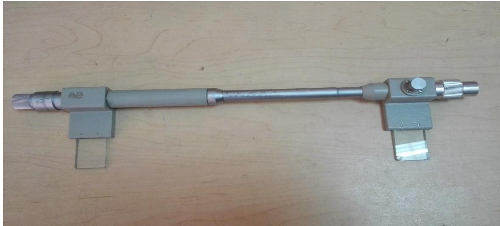
FOTOGRAFÍA 32. BARRA DE PARALAJE PARA MEDICIÓN DE DESPLAZAMIENTO.
