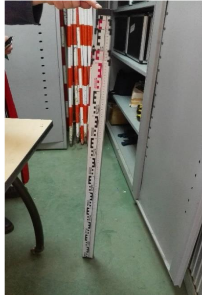
FOTOGRAFÍA 11. MIRA TELESCÓPICA PARA MEDICIÓN VERTICAL.
