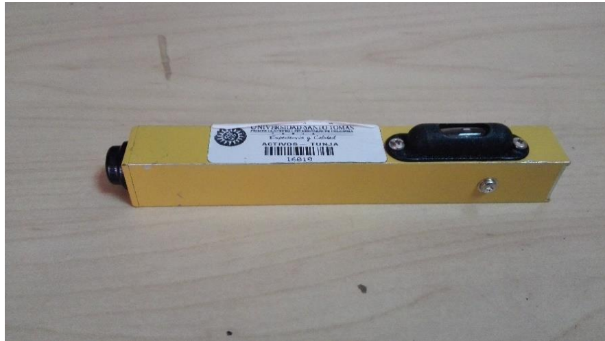
FOTOGRAFÍA 14. NIVEL LOCKE PARA ALTIMETRÍA TOPOGRÁFICA.
