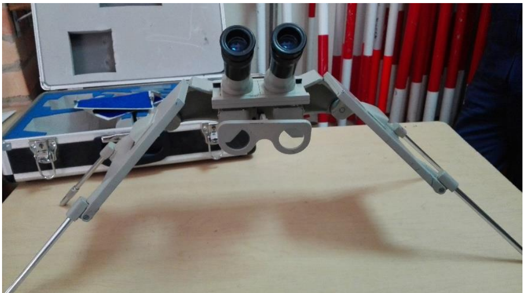
FOTOGRAFÍA 31. VISTA FRONTAL ESTEREOSCOPIO DE ESPEJOS.
