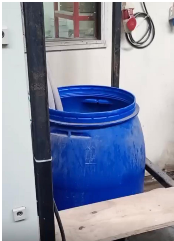
Figura 3.2: Tanque utilizado para la mezcla de agua dulce y reactivos de flotación (MIBC y DF250) antes de la alimentación en la columna piloto.
