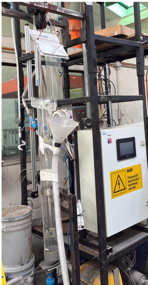
Figura 3.1: Columna de flotación piloto instalada en el laboratorio de Metalurgia, Universidad de Concepción, Chile.
