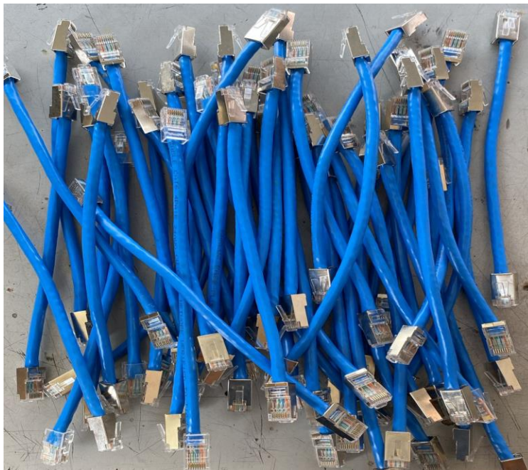
Figura 1. Nuevos cables patch cord ponchados para su instalación en el rack de bodega.
