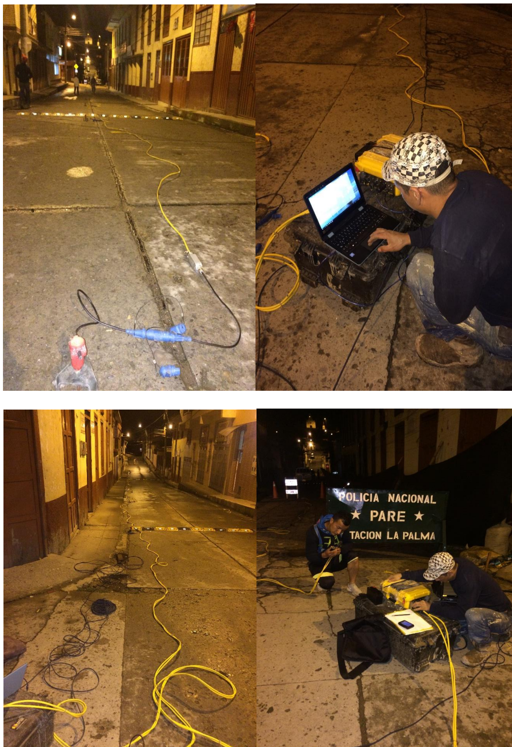
Figura 5 Registro Toma de Línea de Refracción Sísmica. Fuente: Elaboración Propia.
