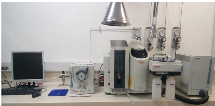
Figura 3. Equipo de absorción atómica acoplado al generador de hidruros. Fuente: Autora
