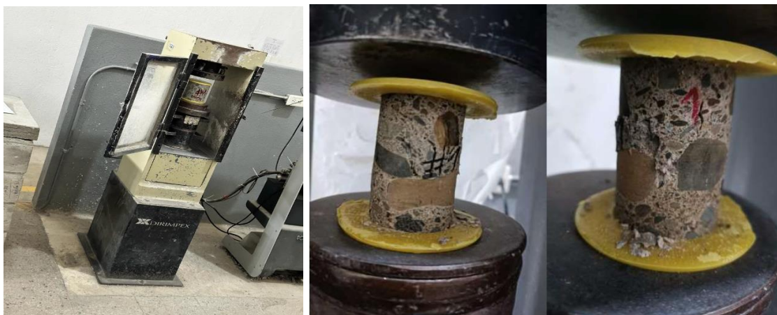
Figuras 66, 67 y 68: Procedimiento Ensayo Compresión de núcleos de concreto 3'' – Casa de Gobierno de Salgar - Antioquia
