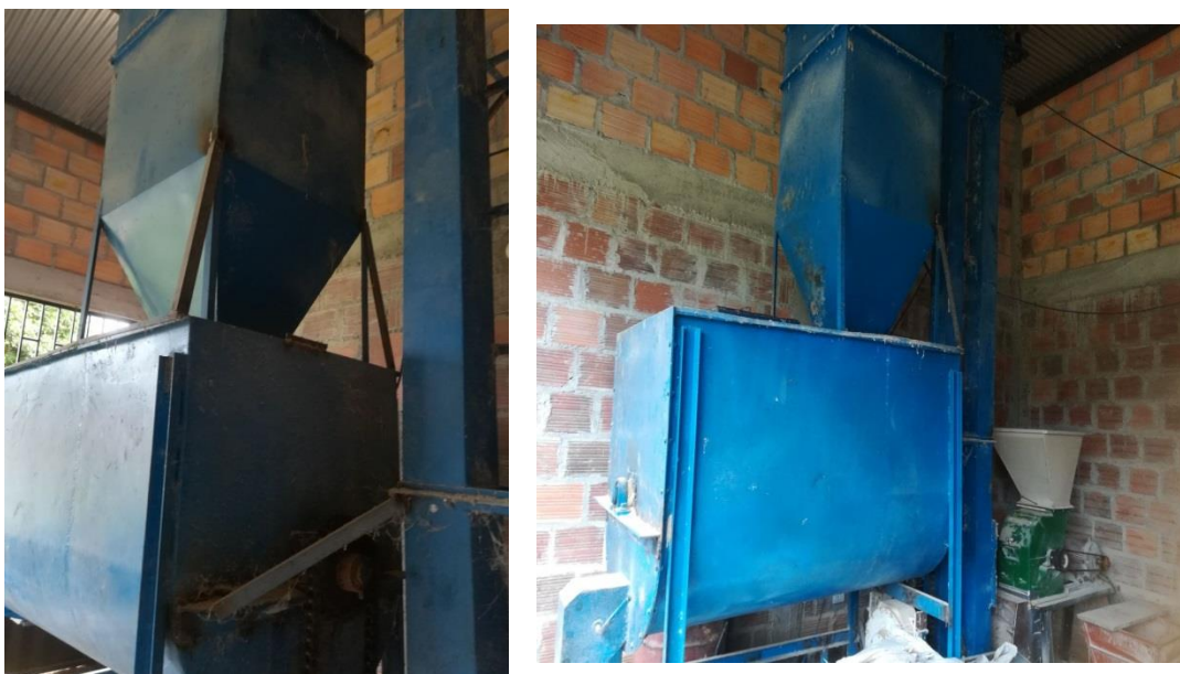
Figura 20. Mezcladora con capacidad para 500 kg (QUALITY PORK S.A.S, 2018).
