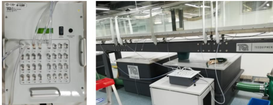
Figura 9-3: Montaje del tablero de presiones. Fuente: Autor.
