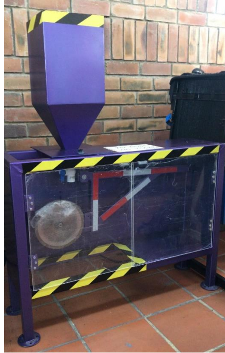
Figura 42. Máquina USTA para ensayos de abrasión en seco
