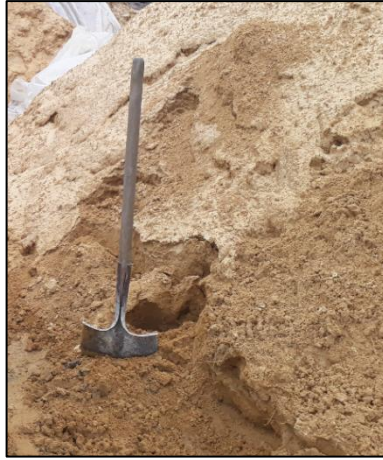
Figura 3. Agregado: Arena de peña
