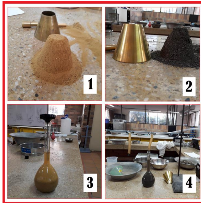
Figura 52. Procedimiento ensayo de densidad y absorción de los agregados finos. Derecha: arena de río, Izquierda: arena de peña. (1) y (2) molde cónico para verificar el estado sss, (3) Comprobación de la temperatura del líquido dentro del picnómetro de 23°C y (4) Picnómetro con bomba de vacío para eliminar burbujas de aire.
