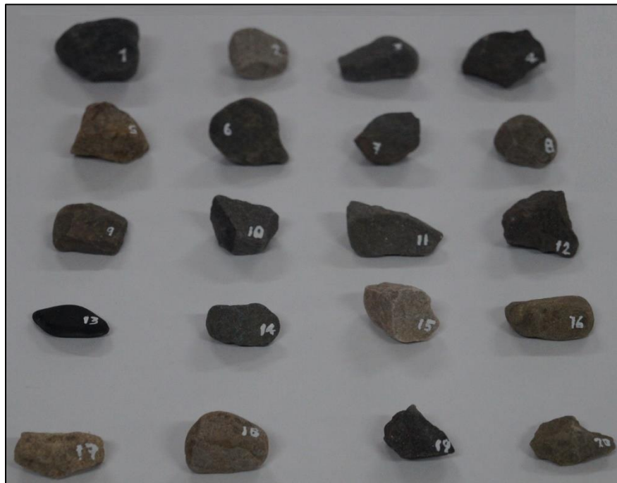
Figura 40. Muestra de triturado de 3/4" para el reconocimiento macroscópico.
