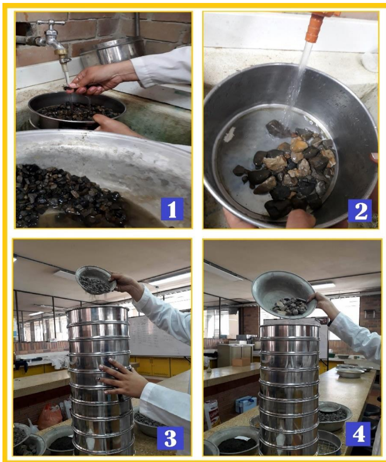
Figura 59. Ensayo para determinar por lavado el material que pasa el tamiz N° 200 y ensayo de granulometría. Izquierda: Triturado de ½", Derecha: Triturado de ¾". (1) y (2) lavado del material de acuerdo a la NTC 78 (3) y (4) Tamizado del material.
