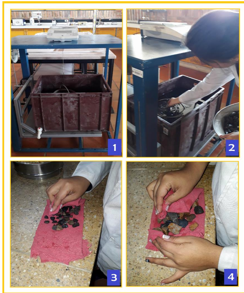
Figura 60. Procedimiento del ensayo de densidad y absorción de agregados gruesos. (1) y (2) Triturado de 1/2" y 3/4" en estado saturado, (3) y (4) Triturado de 1/2" y 3/4" en estado SSS (Saturado y superficialmente seco).
