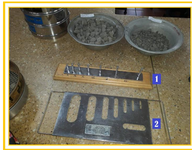
Figura 62. Equipo empleado para ensayo de partículas planas y alargadas (1) Dispositivo de calibración proporcional (2) Calibrador de espesores
