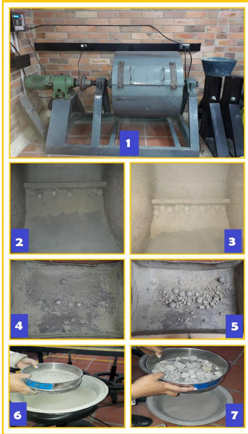
Figura 66. Procedimiento ensayo de desgaste en la máquina de los Ángeles de los agregados grueso. (1) Máquina de los Ángeles, (2) y (3) Triturado de \frac{1}{2} " y de \frac{3}{4} " luego de agitación mecánica dentro de la máquina de los ángeles, (4) y (5) Triturado de \frac{1}{2} " y de \frac{3}{4} " luego de agitación, fuera de la máquina de los ángeles y (6) y (7) Tamizado del triturado de \frac{1}{2} " y \frac{3}{4} " por el tamiz No. 12.
