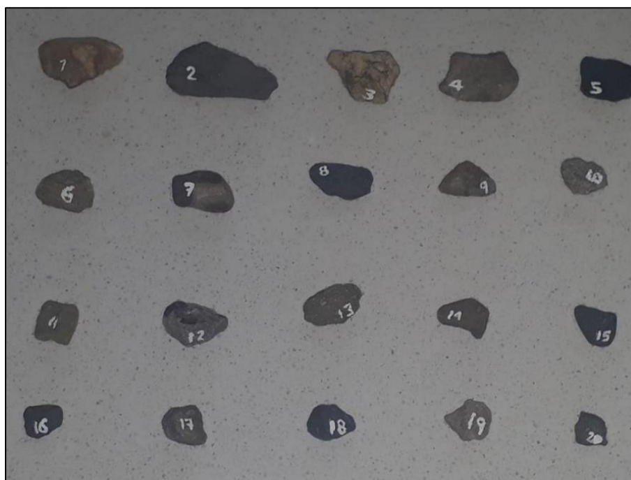
Figura 38. Muestra de triturado de ½” para el reconocimiento macroscópico
