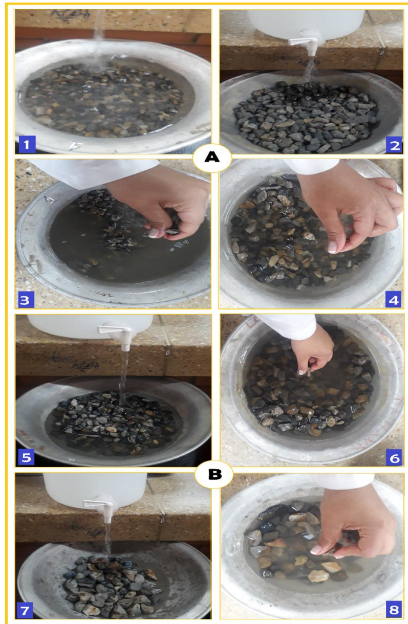
Figura 61. Procedimiento ensayo de terrones de arcilla y partículas deleznable del agregado grueso. (A) Triturado de \frac{1}{2} ", (B) Triturado de \frac{3}{4} ", (1) y (2) Adición de agua destilada a las fracciones entre No 4 – \frac{3}{8} " y entre \frac{3}{8} " – \frac{3}{4} ", (3) y (4) Quebramiento de los terrones de arcilla de las fracciones entre No 4 – \frac{3}{8} " y entre \frac{3}{8} " – \frac{3}{4} ", (5) y (6) Adición de agua destilada a las fracciones entre \frac{3}{8} " – \frac{3}{4} " y entre \frac{3}{4} " y 1 \frac{1}{2} ", (7) y (8) Quebramiento de los terrones de arcilla de las fracciones entre \frac{3}{8} " – \frac{3}{4} " y entre \frac{3}{4} " y 1 \frac{1}{2} ".
