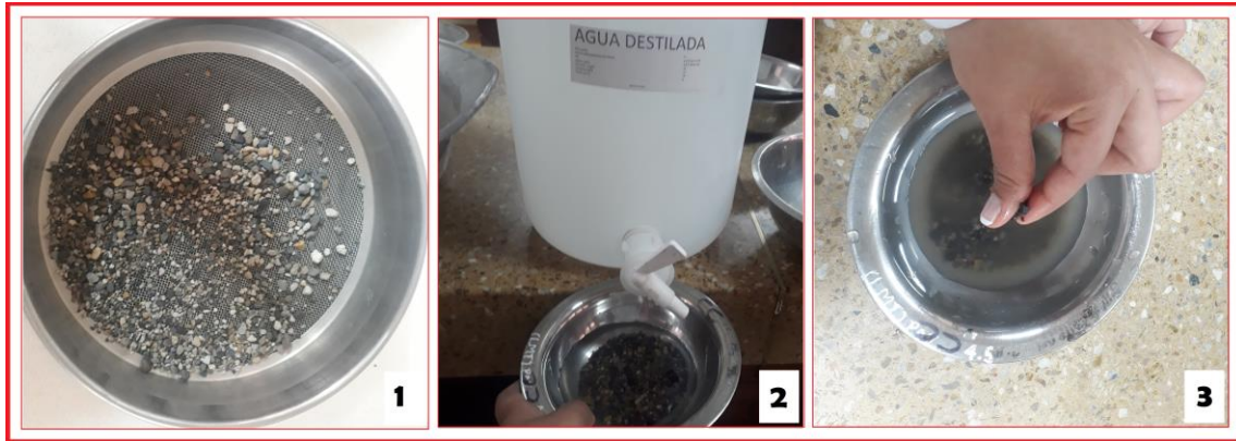
Figura 53. Procedimiento ensayo de terrones de arcilla y partículas deleznales de la arena de río. (1) Tamizado de las partículas de agregado, (2) Adición de agua destilada a la muestra y (3) Quebramiento de las partículas de arcilla del agregado.
