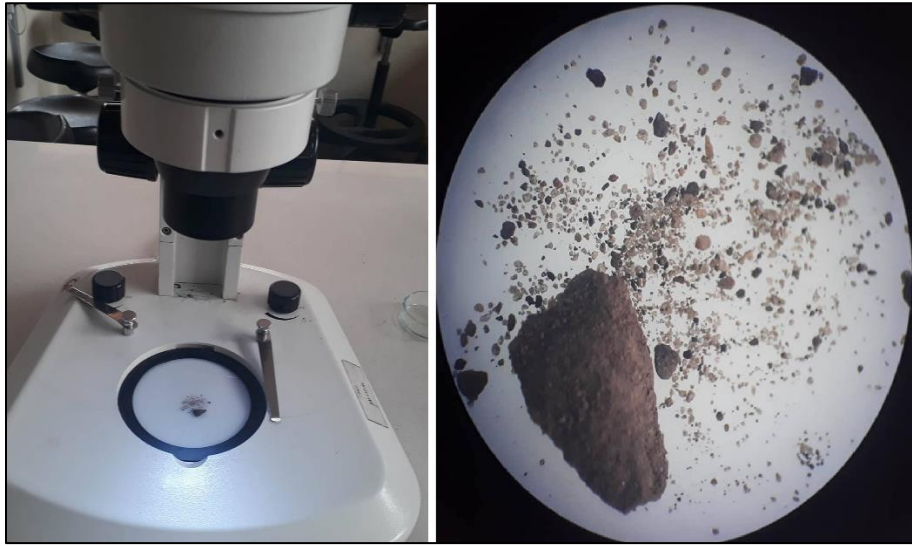
Figura 34. Muestra de arena de río empleada para el reconocimiento macroscópico
