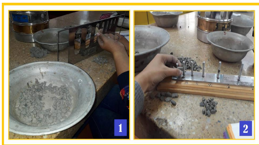
Figura 63. Procedimiento del ensayo de partículas planas y alargadas del agregado grueso (triturado de 1/2" y 3/4" (1) Partículas planas (2) Partículas alargadas
