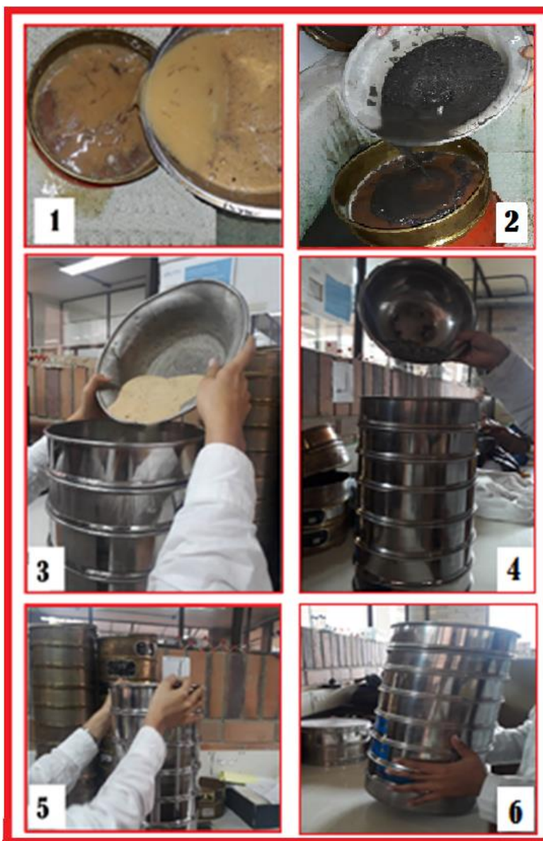
Figura 51. Procedimiento ensayo de granulometría de los agregados finos. Izquierda: Arena de peña, Derecha: Arena de río. (1) y (2) Ensayo de lavado, (3) y (4) Vertimiento de la muestra de agregado en la serie de tamices, (5) y (6) Agitación de los agregados.
