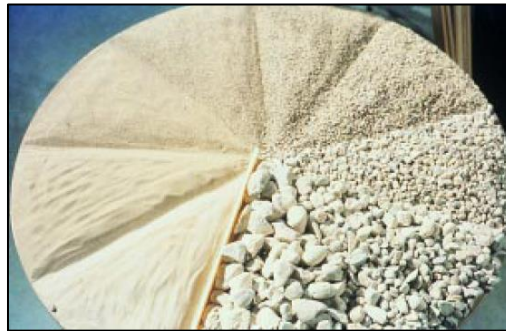
Figura 25. Varios tamaños de partículas que se encuentran en los agregados para uso en concreto.
