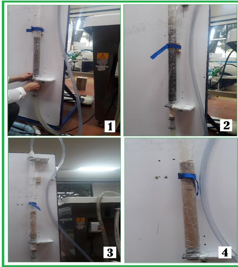
Figura 68. Ensayo de porosidad en el agregado fino. 1) y 2) Arena de río, montaje y expansión respectivamente 3) y 4) Arena de peña, montaje y expansión respectivamente.
