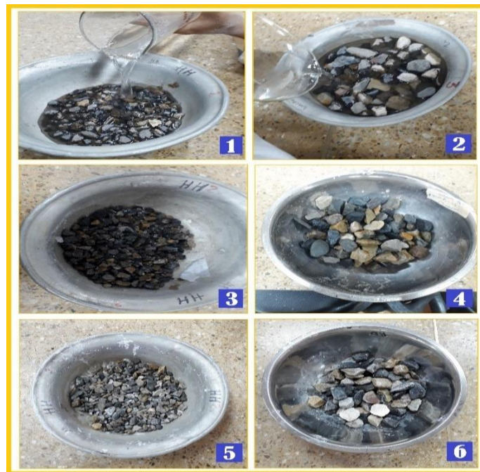
Figura 64. Procedimiento ensayo de sanidad en agregado grueso. Derecha: triturado de 1/2" retenido en N° 4, Izquierda: triturado de 3/4" retenido en 1/2" (1) y (2) Muestras en inmersión, (3) y (4) muestras después de drenar la solución por 15 minutos, (5) y (6) muestras secas al horno hasta masa constante.
