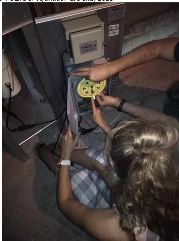
Figura 17. Calibración del HI-VOL. Por Afanador & Peña, 2019
