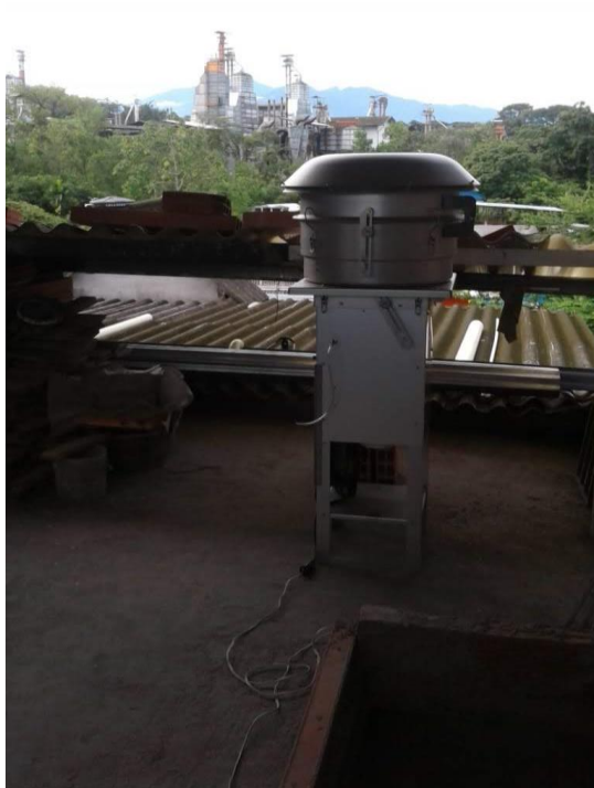
Figura 22. Montaje del Muestreador de Alto Volumen. Por Afanador & Peña, 2019
