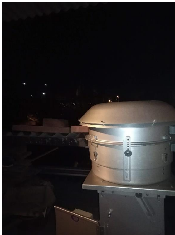
Figura 23. Montaje del Muestreador de Alto Volumen. Por Afanador & Peña, 2019
