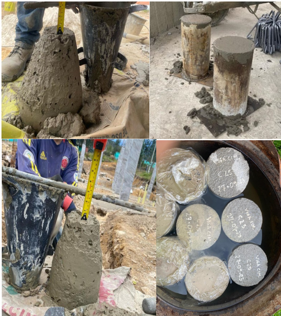
Figura 24: Ensayo de asentamiento, encofrado de cilindros a compresion y fraguado de estos.
