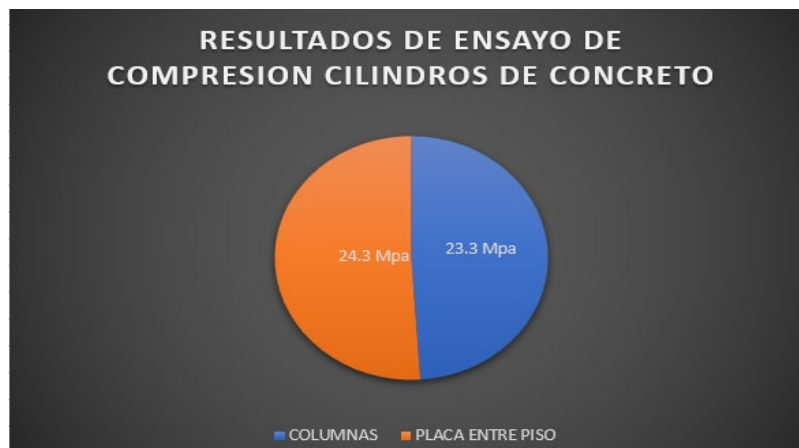
Grafico 5: Resultado de ensayo de compresion cilindros de concreto echos por el pasante. [4]
