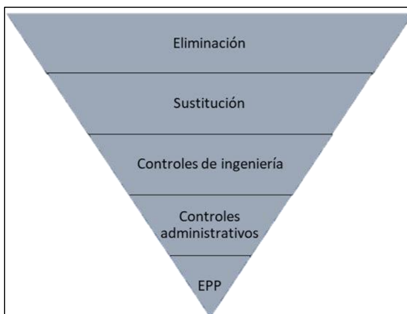
Figura 23. Jerarquía de control de riesgos.
