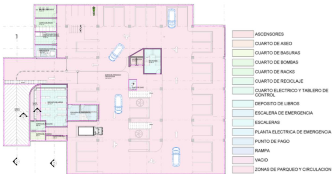
Figura 36. Zonificación sótano nivel -1
