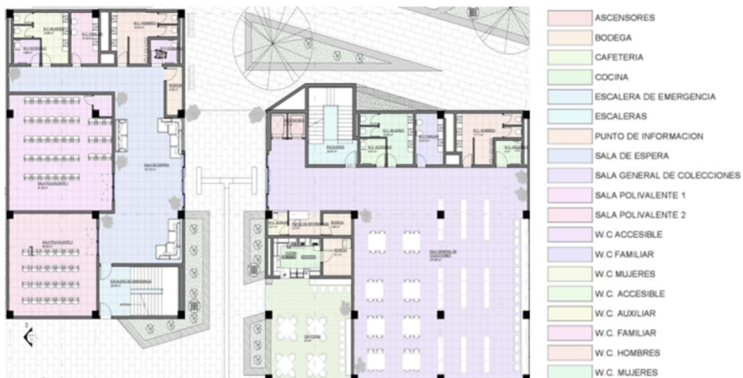
Figura 38. Zonificación segundo piso
