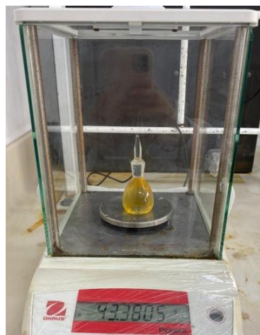
Figura 23. a). Medida de la masa del picnómetro vacío. b). Medida de la masa del picnómetro lleno de la sustancia oleosa seleccionada
