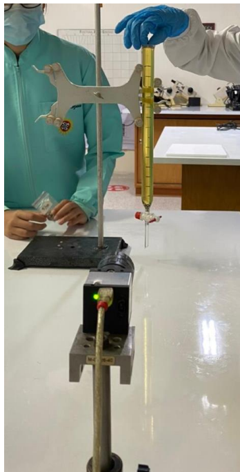
Figura 26. Montaje experimental en el cual se aprecia la columna de cromatografía y el sistema de adquisición del video
