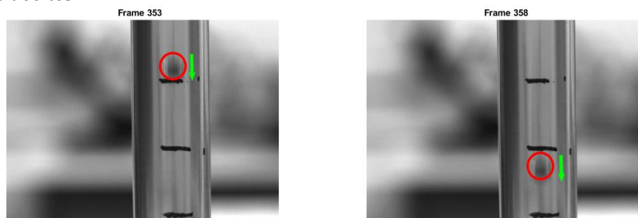
Figura 27. Seguimiento del balón en la columna de cromatografía cuando pasa entre las marcas seleccionadas en el estudio para determinar el tiempo y posteriormente la velocidad promedio en de este en los aceites
