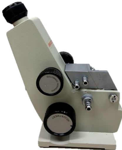
Figura 29. Refractómetro análogo tipo Abbe
