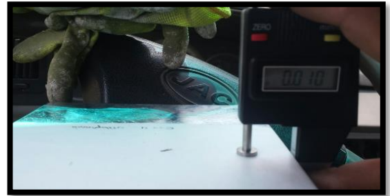
Fotografía 3. Toma de espesor seco con medidor de espesor digital.
