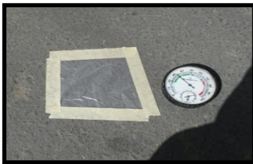
Fotografía 1. Prueba de contenido de humedad y medición con higrómetro de piso.
