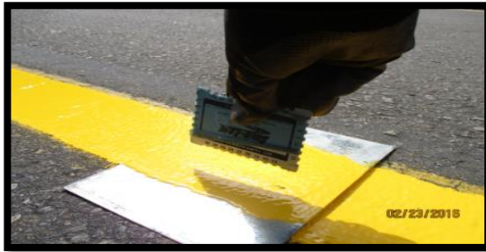
Fotografía 2. Lamina de muestra y galga para espesor húmedo.
