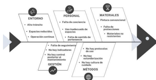
Figura no. 1. Diagrama de causa-efecto del deterioro prematuro de los acabados.
