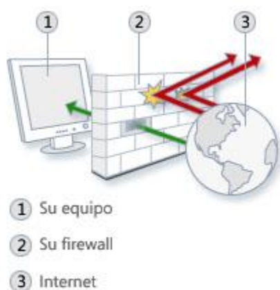
Figura 16 Funcionamiento del Firewall.
