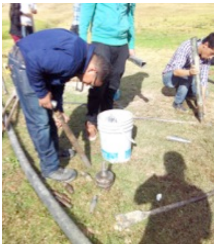
Fotografía 39. Toma de SPT
