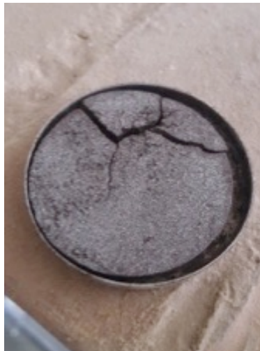
Fotografía 7. Ensayo de límite de contracción.
