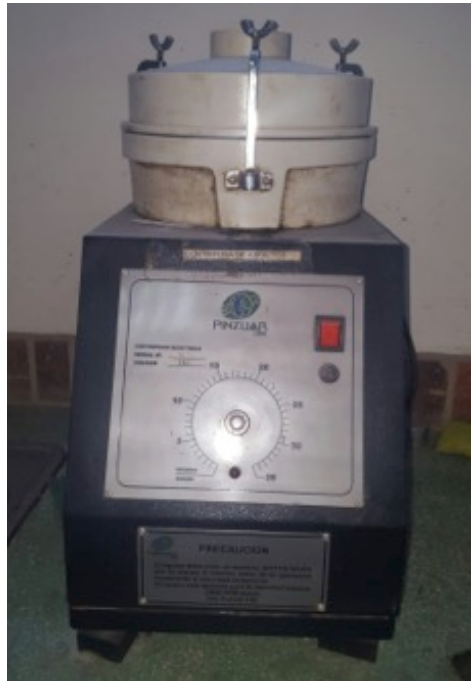
Fotografía 11. Equipo de centrifugado de asfalto.
