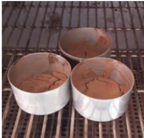
Fotografía 5. Ensayo de límite líquido.
