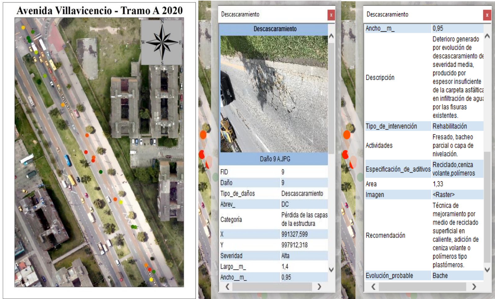
Figura 21. Visualización de la ubicación de los daños en el tramo A con su descripción y registro fotográfico. Cogollos Franco A.G., & Martínez Rodríguez M.L., (2020)
