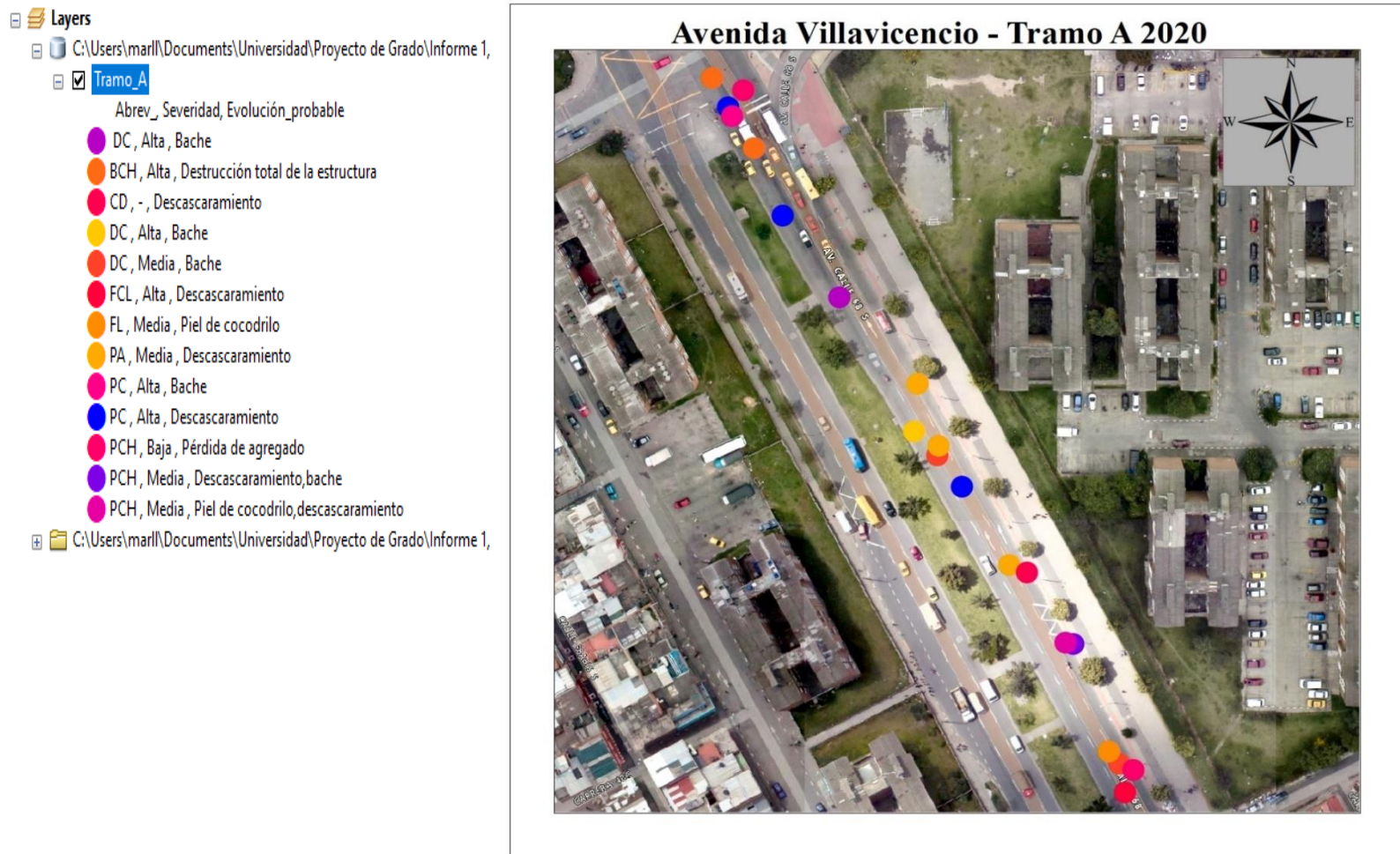
Figura 23. Zonificación realizada con la categorización del tipo de daño presentando una gama de colores de acuerdo a la severidad y evolución probable del mismo. Cogollos Franco A.G., & Martínez Rodríguez M.L., (2020)
