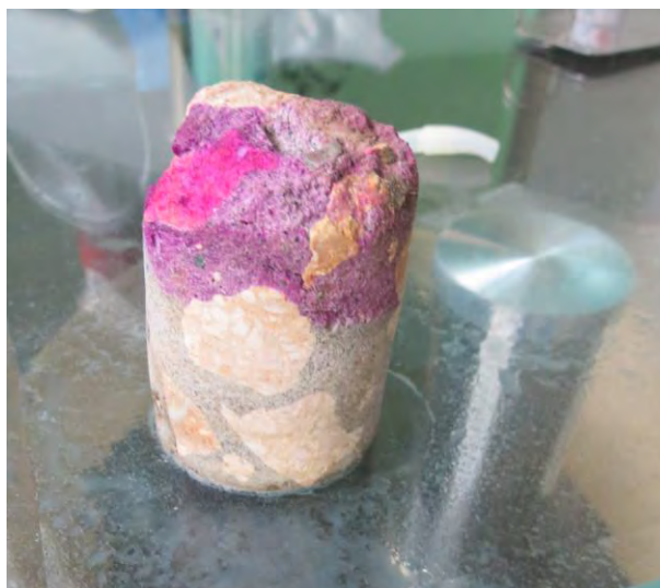
Foto 5 : Ensayo de Carbonatación
