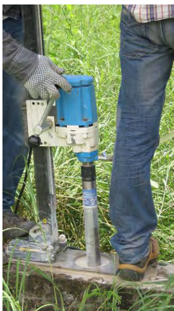
Foto 1 y 2: Extracción de Nucleos de Concreto para Verificación Resistencia.
