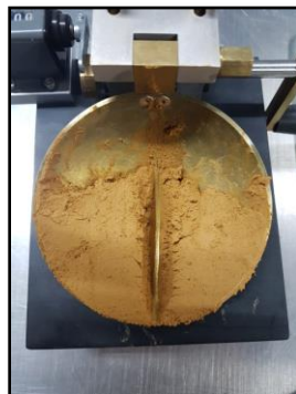
Fig. 2 CAZUELA DE CASAGRANDE CON RANURA
