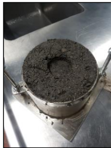
Fig. 12 ENSAYO CBR MATERIAL CRUDO DE RÍO
