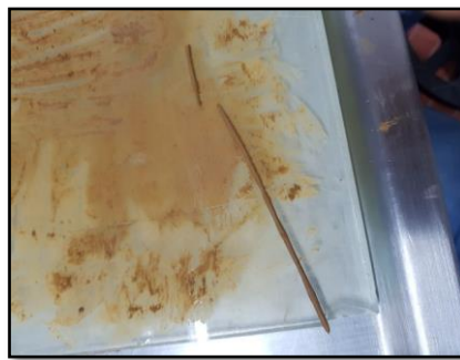
Fig. 3 ROLLO LÍMITE PLÁSTICO
