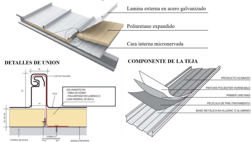
Figura 64. Detalles de cubierta. Componente técnico.
