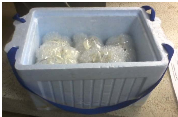
Muestras puestas sobre nevera de icopor para conservar temperatura y preservar equilibrio.
