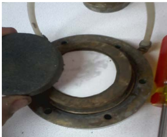
Piedra porosa colocada sobre la parte superior de la muestra para garantizar condición drenada.
