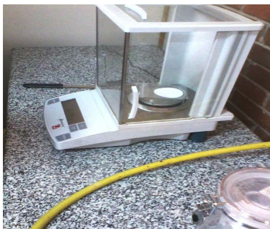
Papel Whatman # 42 (calibrado), usado para medir succión
