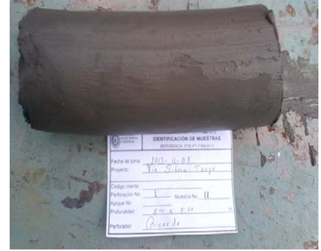
Arcilla encontrada a los 20 metros de profundidad
