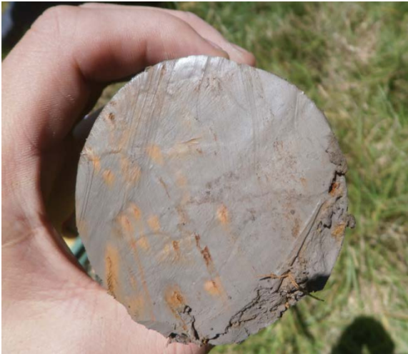
Arcilla encontrada en los primeros seis metros, levemente fisurada, con oxidaciones y con presencia de raíces
