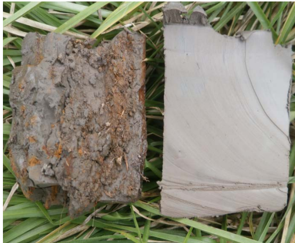
Arcilla encontrada en los primeros seis metros (Izquierda) vs arcilla encontrada a los quince metros (Derecha).
