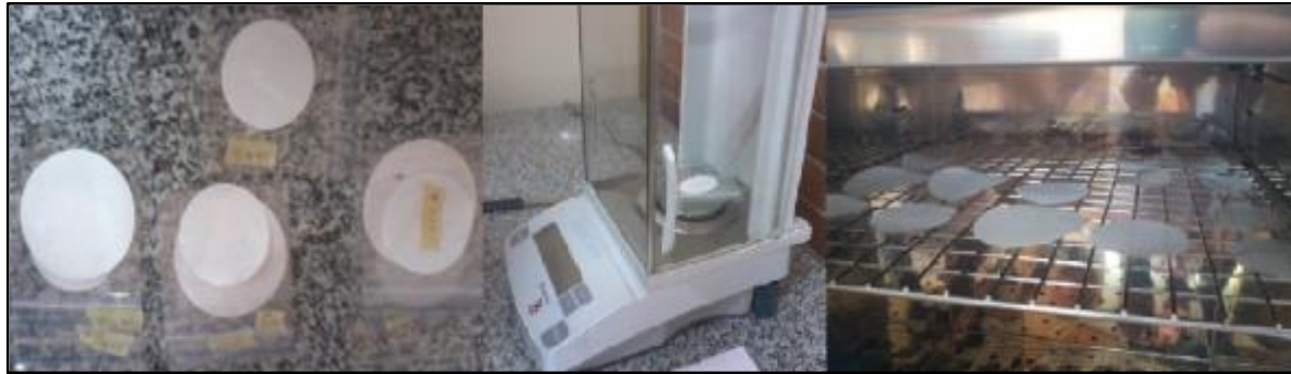
Figura 4- 20. Determinación de humedad del papel filtro.
