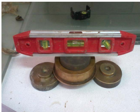
Revisión de nivel sobre la muestra
