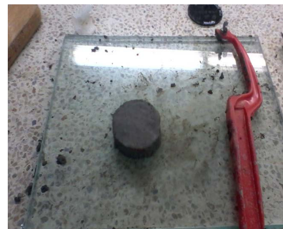
Muestra en proceso de tallado
