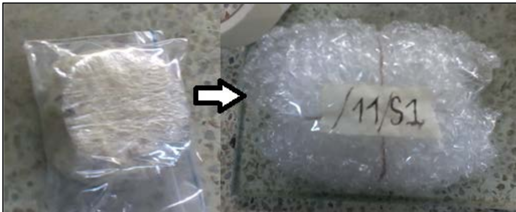
Figura 4- 18. Espécimen de suelo envuelto en bolsa de cierre hermético, papel vinipel, y papel de aire sellado.
