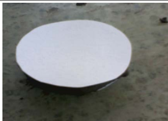
Papel filtro en contacto directo con muestra de suelo.
