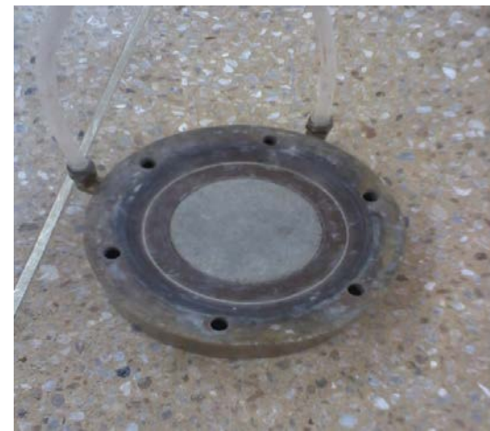
Piedra porosa y papel filtro colocadas sobre la base de la cámara de consolidación
