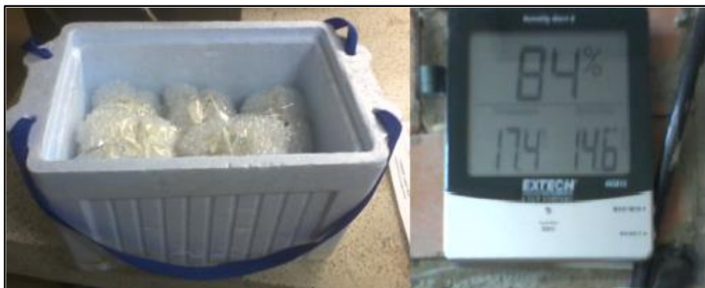
Figura 4- 19. Almacenamiento de muestras en nevera de icopor (Izq.) junto a medidor de temperatura y humedad de la cámara hermética.
