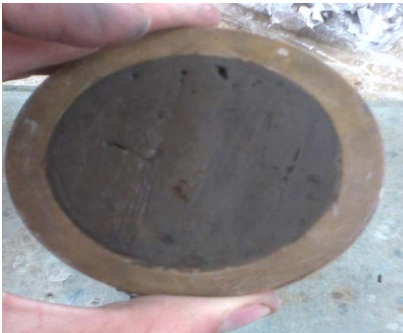
Muestra debidamente colocada en el anillo
