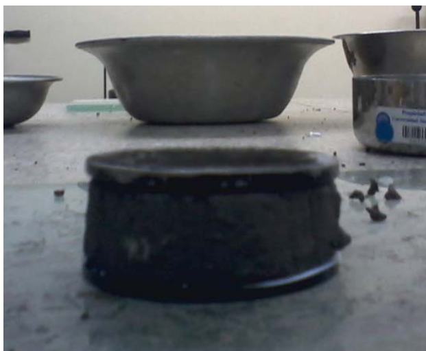
Acrílicos colocados en tope y base de la muestra.
