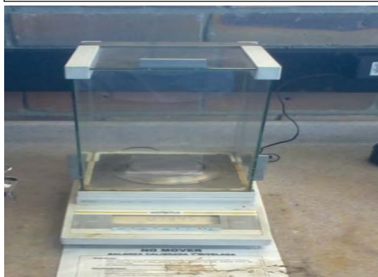
Balanza de precisión 0.0001 usada para el ensayo o.
