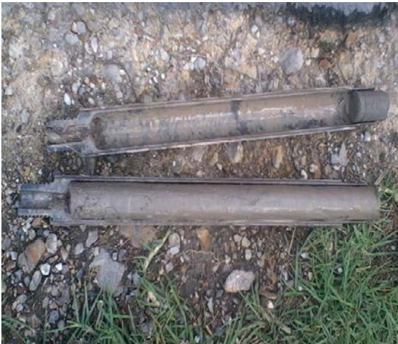
Extracción de muestras a partir de tubo SPT.
