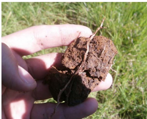
Arcilla encontrada en los primeros metros, con alto contenido de materia orgánica
