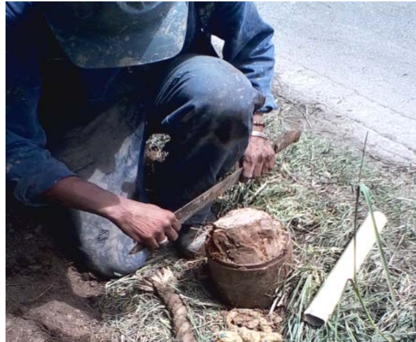
Extracción muestra en Molde CBR.
