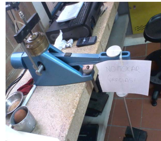
Consolidación en ejecución.
