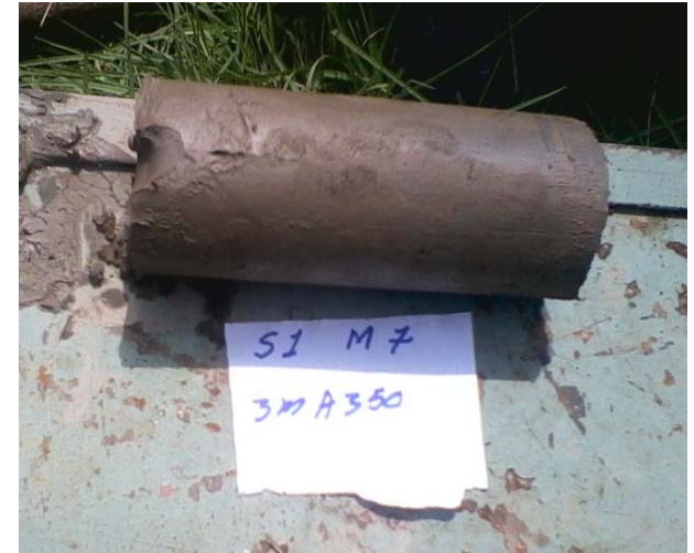
Arcilla encontrada de 3.00 a 3.50 metros para el sondeo 1
