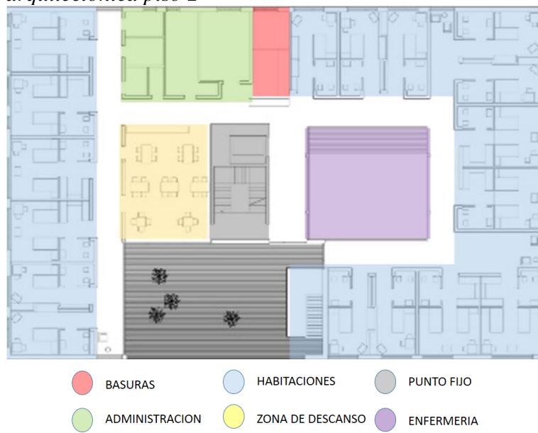
Figura 13. Planta arquitectónica piso 2
