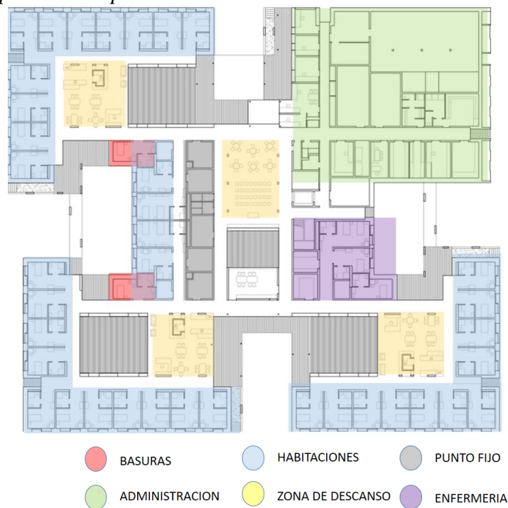
Figura 2. Planta arquitectónica piso 1
