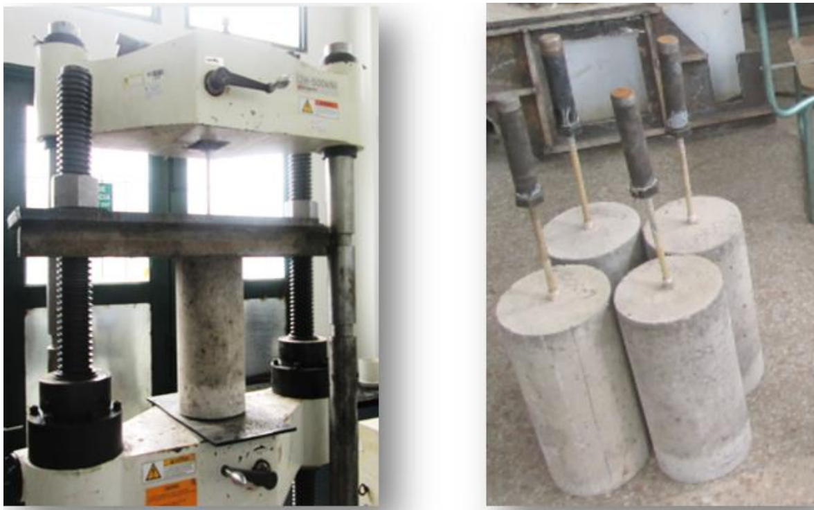
Imagen 9 Análisis del comportamiento a tracción, doblado y anclaje de barras corrugadas de GFRP.
