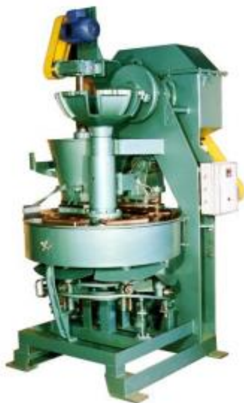
Figura 34. Prensa mecánica. Adaptado: técnicas de construcción con tierra
