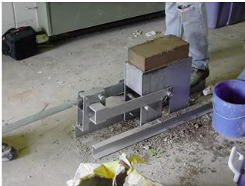
Figura 33. CINVA-RAM manual. Adaptado: Open Source Ecology (17 de octubre del 2017)
