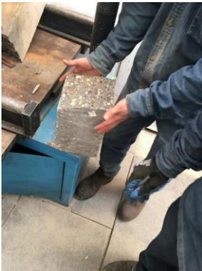
Ilustración 57 ensayo viga a flexión
