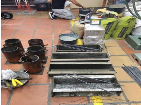
Ilustración 38 Formaletas utilizadas elaboración especímenes
