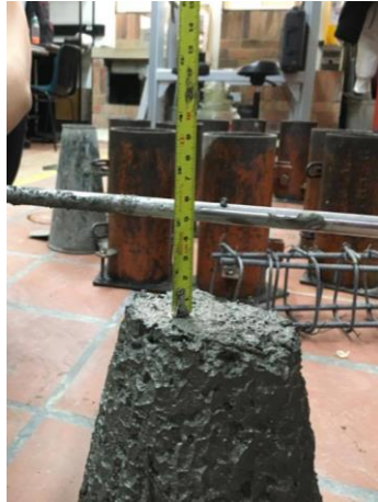
Ilustración 37 medición asentamiento de la mezcla
