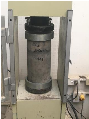
Ilustración 52 ensayo cilindros resistencia a la compresión
