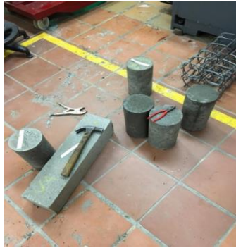
Ilustración 49 Desencofrado especímenes mezcla 1
