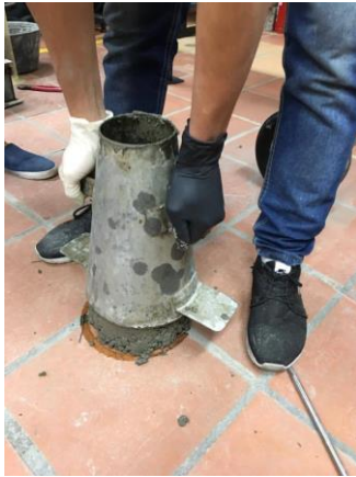
Ilustración 35 retiro cono abrams
