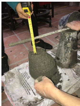
Ilustración 45 Asentamiento de mezcla 5
