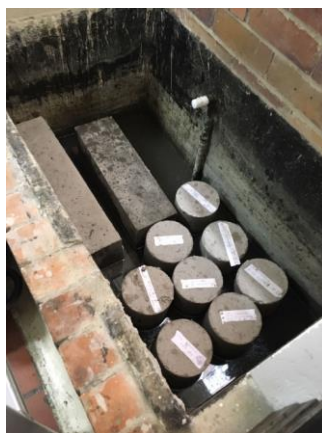
Ilustración 51 Desencofrado especímenes mezcla 3
