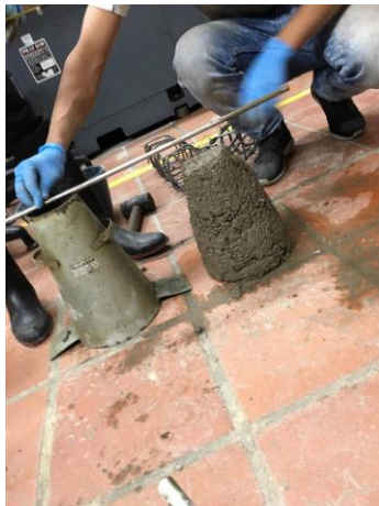
Ilustración 36 validación asentamiento de la mezcla
