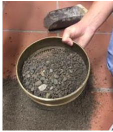
Ilustración 15 Agregado Grueso que pasa por el Tamiz 4
