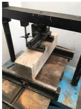
Ilustración 58 ensayo viga a flexión
