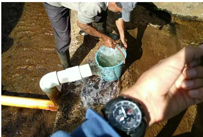
Imagen 5 Método implementado para aforar corrientes de agua
