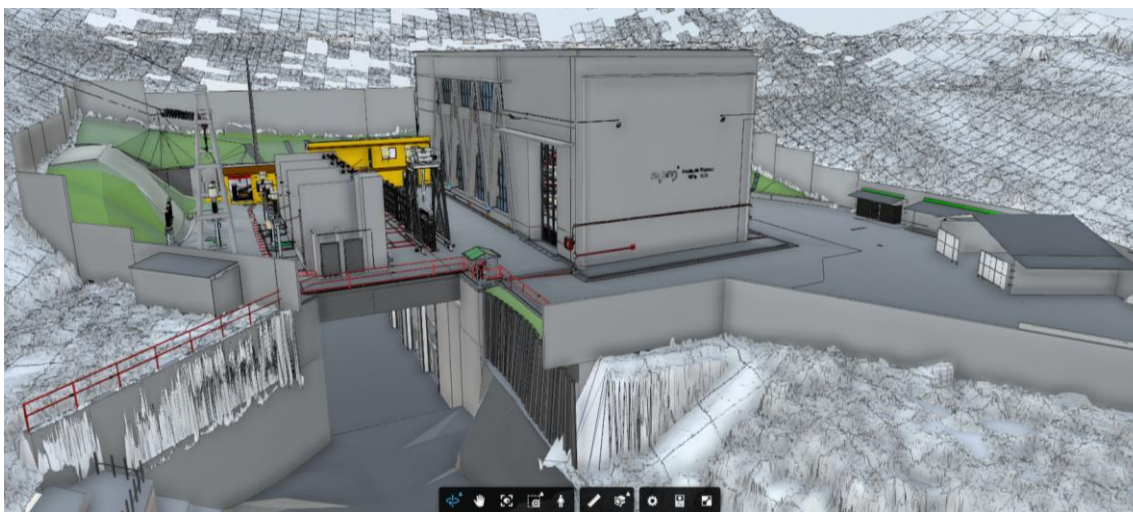
Figura 2. Captura de modelo desarrollado en Revit a partir de nube de puntos. Casa de máquinas Troneras
