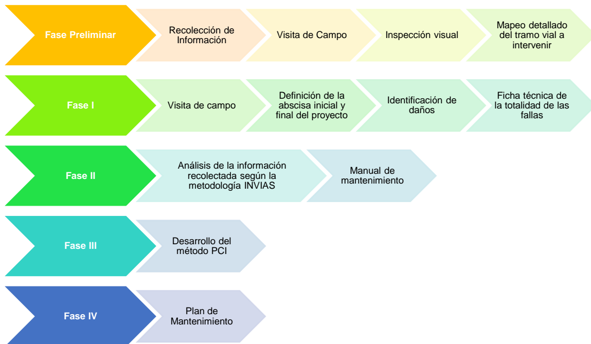
Ilustración 7-1. Metodología para el plan de mantenimiento para la estructura de pavimento del tramo de la calle 35 entre carrera 4 Norte y carrera 15 Este, en la ciudad de Villavicencio – Meta
