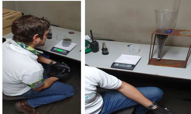
Figura 50. Determinación de la saturación por humedad en laboratorio. Propia (2019).
