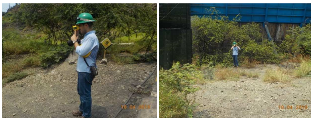
Figura 39. Determinación de la pendiente en el área de estudio con equipo electrónico (Hipsómetro). Propia.2019
