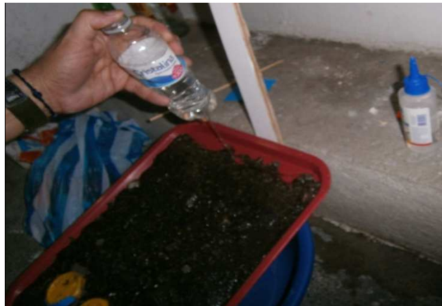
Figura 56. Aplicación controlada de la precipitación sobre la Cuenca#2. Propia (2019)
