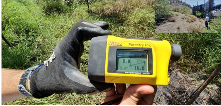
Figura 51. Determinación de la pendiente en campo (Hipsometro). Propia (2019)
