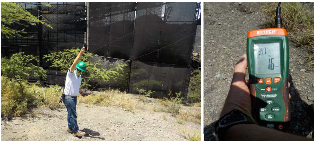
Figura 47. Determinacion de la temperatura y velocidad del viento. Cerros de punta betin. Propia.2019
