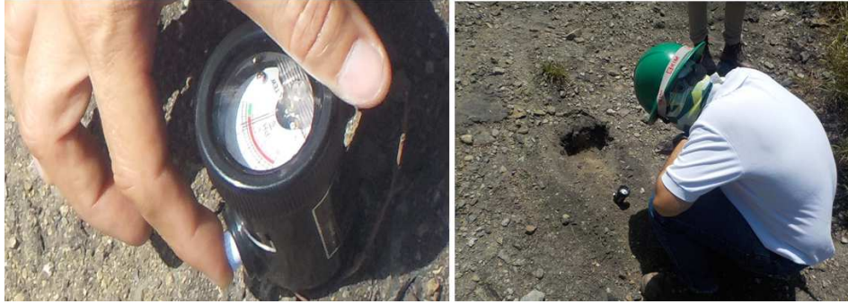
Figura 49. Determinación de la temperatura del suelo. Cerros de punta Betin. Propia.2019
