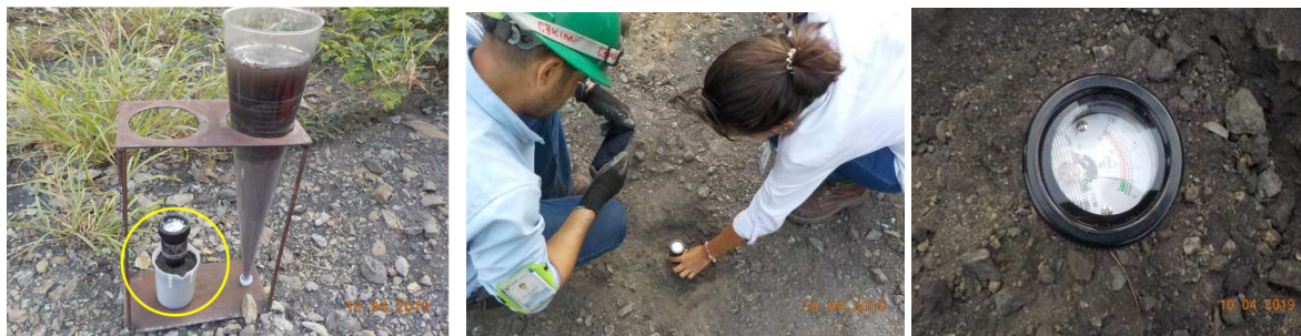
Figura 40. Determinación de la humedad del suelo mediante dos metodos y un equipo. Propia.2019
