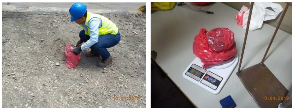
Figura 41. Toma de muestra en area de estudio para pruebas de conductividad hidraulica. Propia.2019
