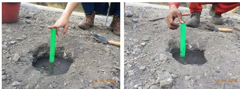
Figura 43. Determinacion de la capacidad de infirltracion del terreno.Cerros de punta Betin.Propia (2019)
