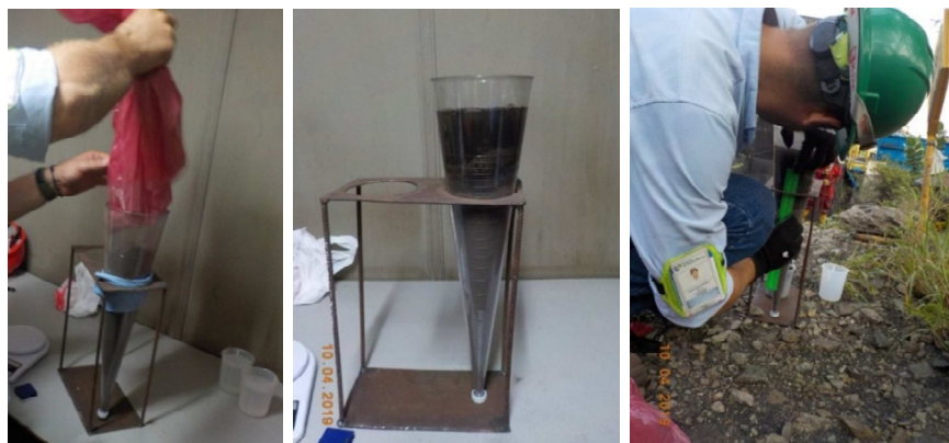
Figura 42. Toma de muestra en area de estudio para pruebas de conductividad hidraulica. Propia.2019
