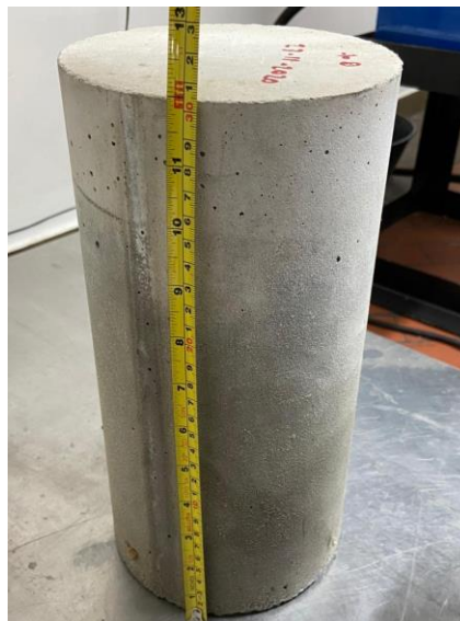
Figura 4 Preparación de los cilindros para fallarlos.
