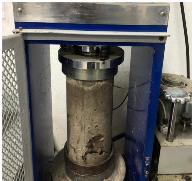
Figura 6 Falla de cilindro 5-6.
