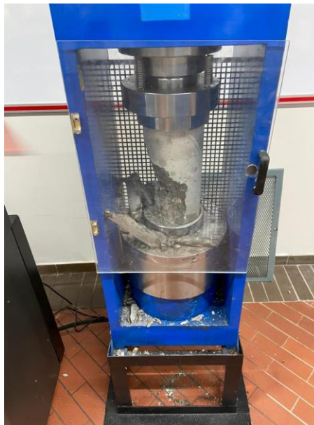
Figura 9 Falla del cilindro 25-6 (28 días).
