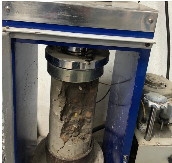
Figura 5 Falla de cilindro 0-5.
