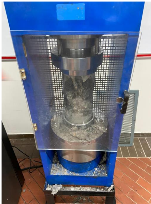
Figura 7 Falla del cilindro 10-5 (28 días).
