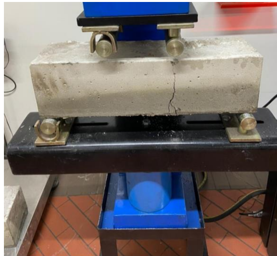
Figura 14 Viga de concreto con dosificación de 20 kg/m 3 , 20-5V.
