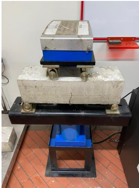
Figura 15 Viga de concreto con dosificación de 25 kg/m 3 , 25-6V.
