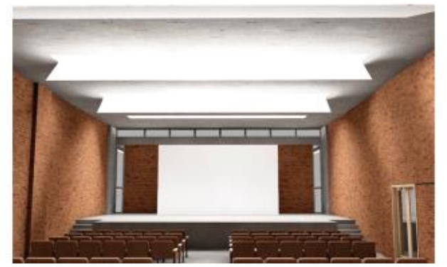
Reflexión del sonido en paneles reflectantes
