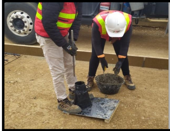
Fotografía 27 Ensayo de Asentamiento del Concreto Fuente: Autor
