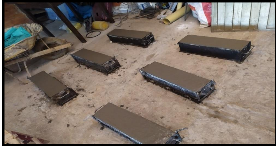
Fotografía 25 Vigas de Concreto a falla de Flexión Fuente: Autor
