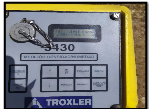
Fotografía 16 Resultado Densidad Seca, con densímetro nuclear. Fuente: Autor
