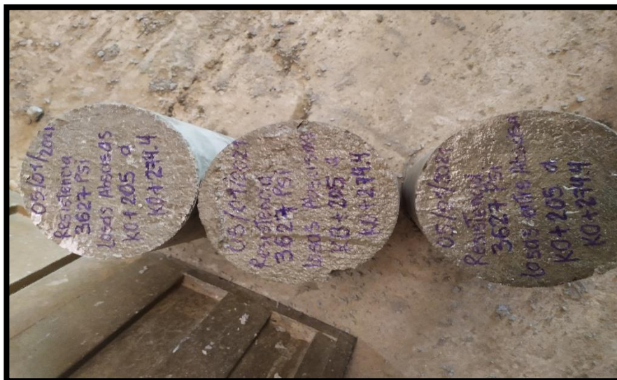
Fotografía 26 Cilindros de Concreto a falla de Compresión Fuente: Autor
