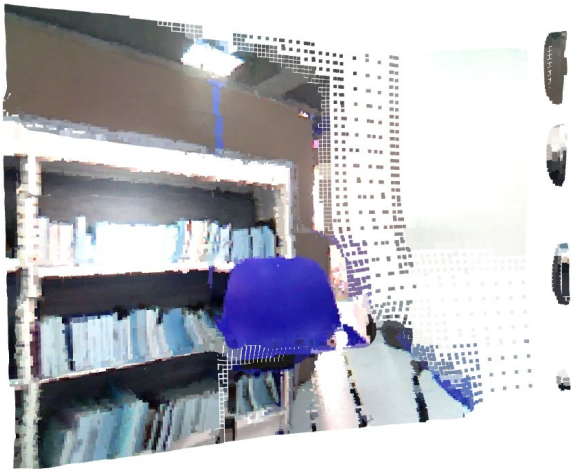
Fig. 8. Mosaico con fusión de Información de Profundidad con muestras cada 20cm y filtro de distancia de 150cm y 300cm para mínimo y máximo respectivamente.
