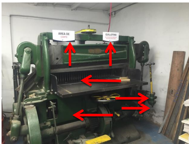
Figura 16. Señalización informativa y la advertencia de peligros
