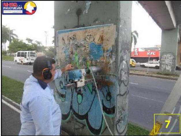
Imagen 5. Extracción de núcleos columnas.
