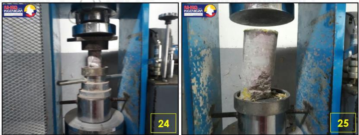
Imagen 9. Falla de núcleos de concreto.
