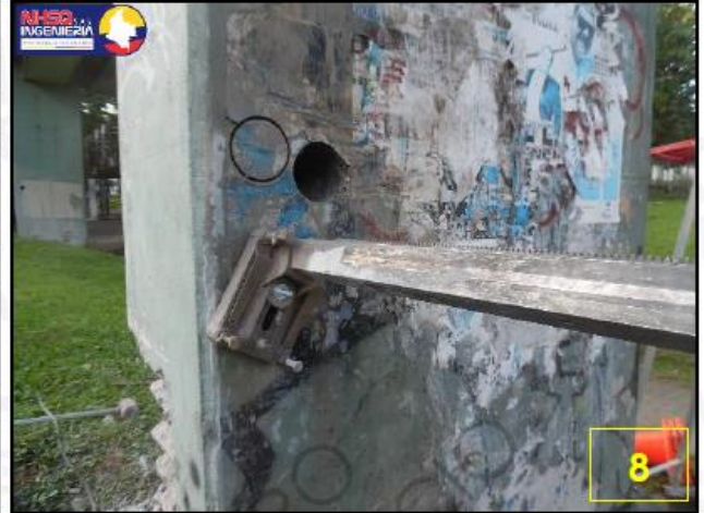
Imagen 5. Extracción de núcleos columnas.
