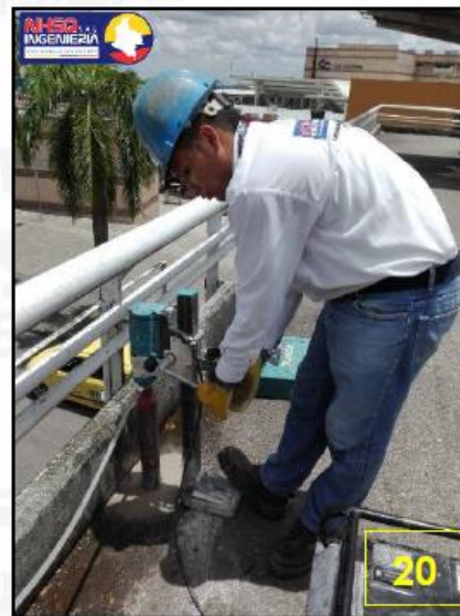
Imagen 7. Extracción núcleos placa
