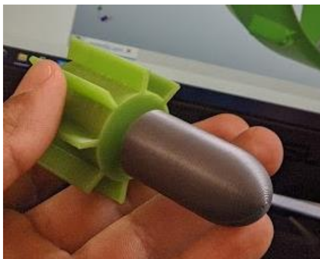
Figura 81. Prueba de ajuste del acople
