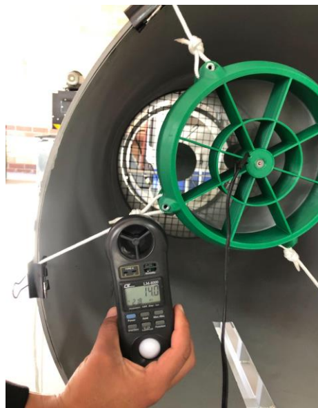
Figura 86. Medición de la velocidad del viento
