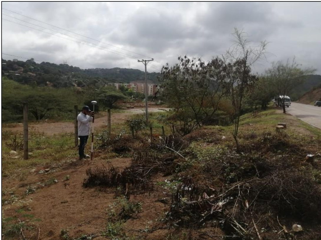
Figura 20. Punto de control con el Rover GNSS
