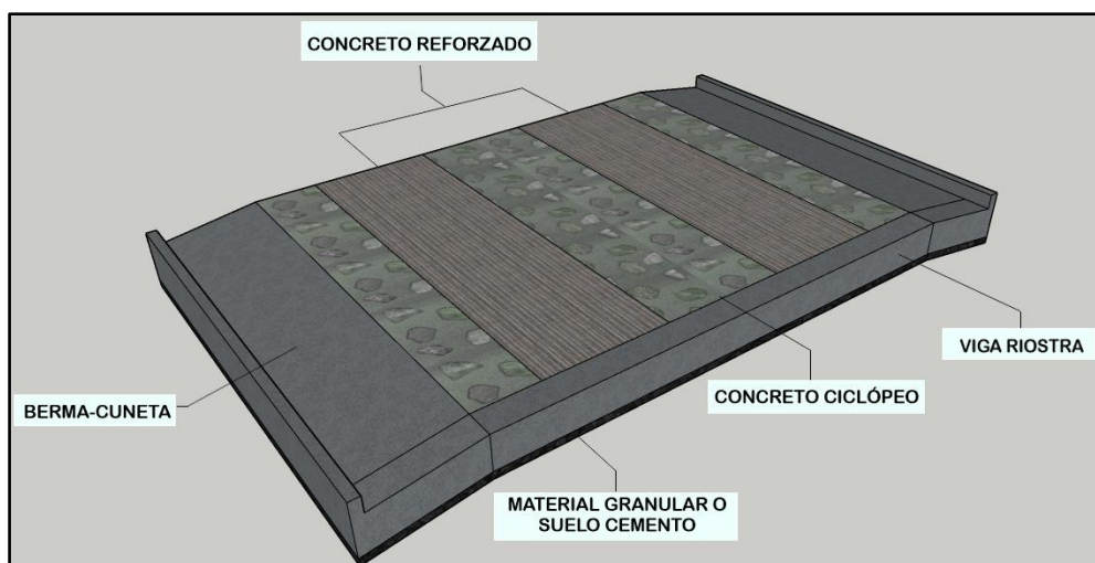
Figura 1. Elementos de una placa huella.
