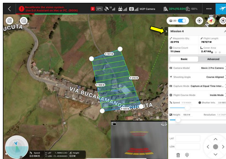
Figura 44. Plan de vuelo con puntos ajustados
