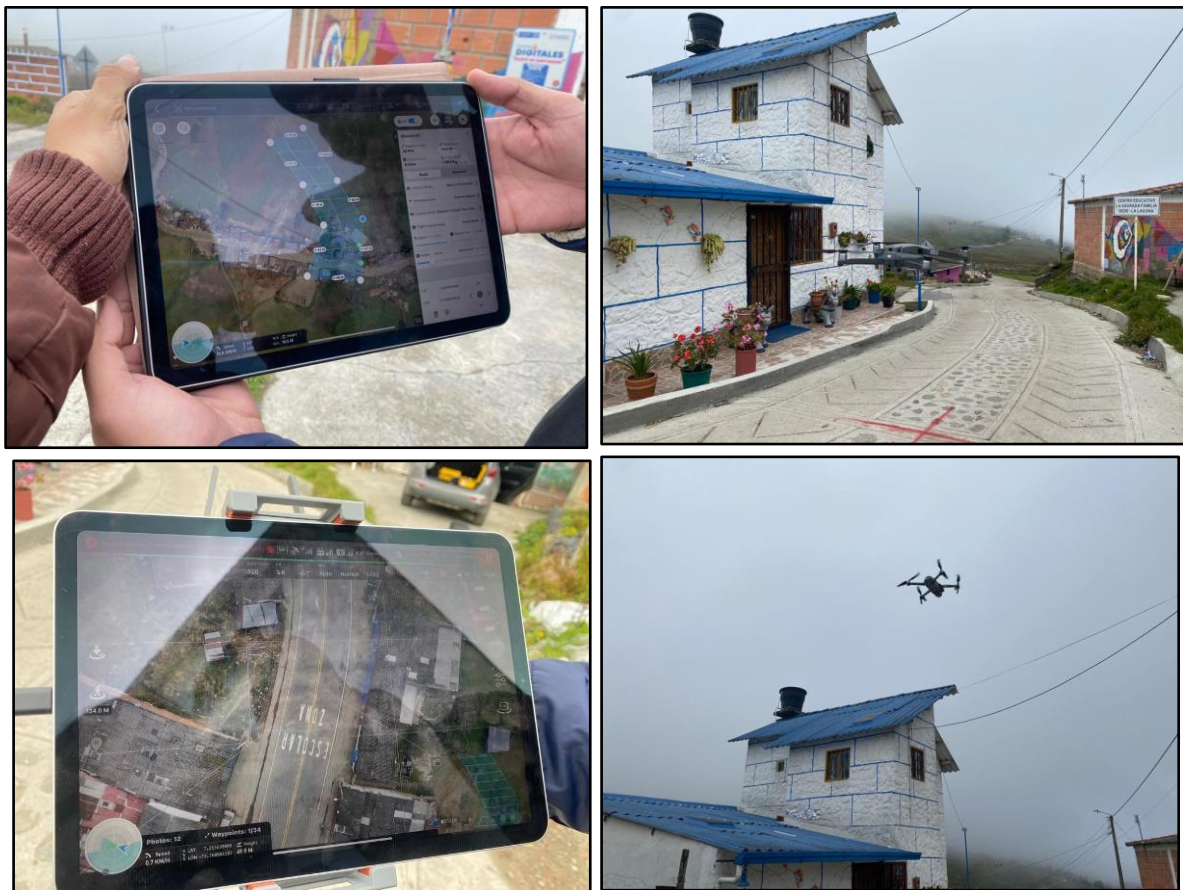
Figura 48. Levantamiento topográfico mediante Dron
