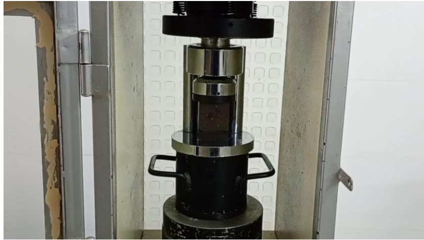
Figura 28. Máquina hidráulica de compresión adaptada para el fallo de cubos
