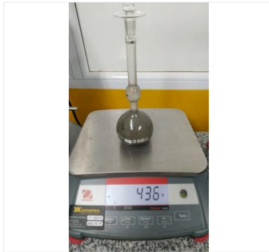
Figura 22. Peso del frasco con el cemento.
