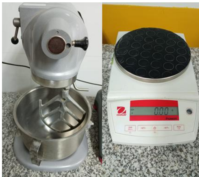
Figura 33. Mezcla y fundida de los cubos de mortero.
