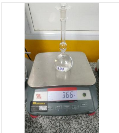
Figura 16. Peso del frasco con el aceite.
