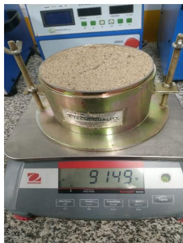
Figura 12. Muestra compactada y nivelada.
