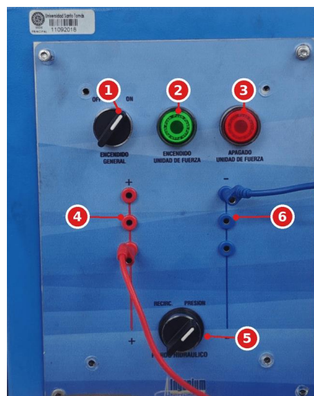
Figura A.1 — Tablero de encendido del banco: 1 encendido general, 2 encendido de la unidad de fuerza, 3 apagado de la unidad de fuerza, 4 línea de 24 VDC, 5 muletilla de fluido (recirculación/presión), 6 línea de 0 VDC.
