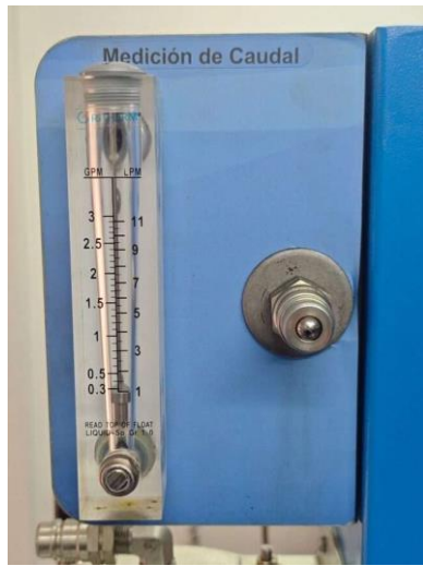
Figura D.5 — SOP-05: rotámetro empleado en la medición de caudal.
