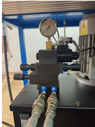
Figura D.4 — SOP-04: bloque de la válvula limitadora con manómetro empleado en la calibración.
