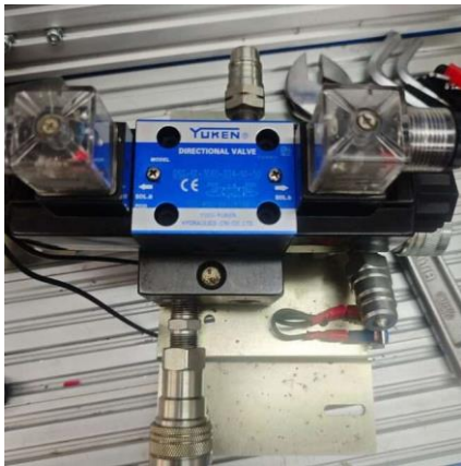
Figura E.7 — Electroválvula direccional YUKEN DSG-01 con conmutación verificada.
