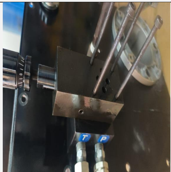
Figura E.3 — Electroválvula con falla de conmutación del solenoide.
