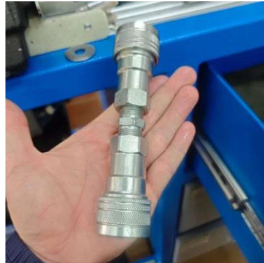
Figura D.2 — SOP-02: acoples rápidos DN-06 verificados durante el montaje del circuito.
