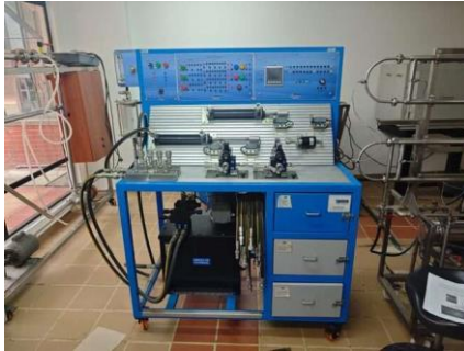
Figura E.5 — Vista general del banco oleohidráulico en operación.
