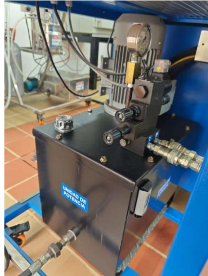
Figura E.6 — Unidad de potencia operativa (depósito, bomba y motor SIEMENS).
