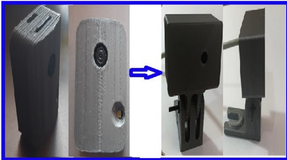
Figura 27. Modificación de la carcasa del módulo ESP32.
