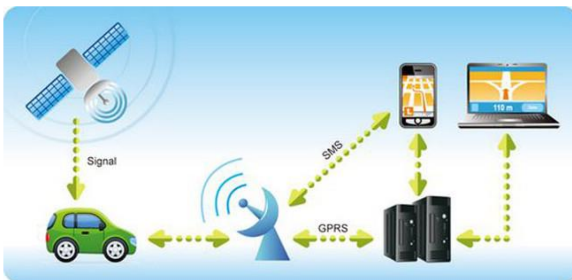
Figura 3. Sistema de transmisión de GPRS.
