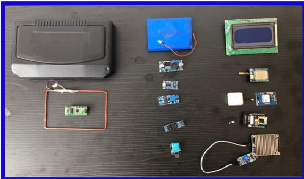
Figura 15. Carcasa, sensores, batería y pantalla del dispositivo.
