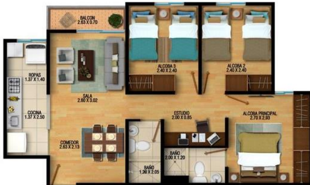
Figura 3. Planta de vivienda actual, estrato 4 (78m 2 )
