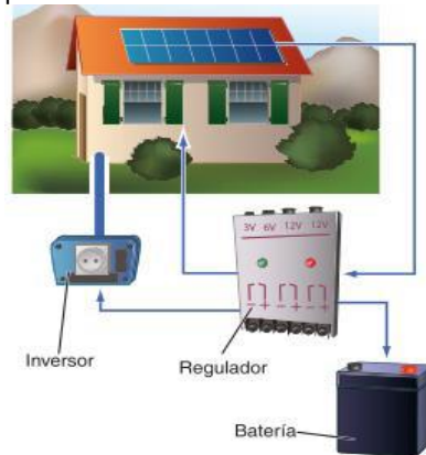
Ilustración 3. Componentes de una instalación fotovoltaica autónoma [14].
